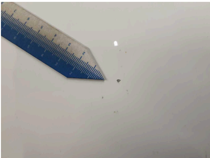
Damage 8: Bonnet: Bonnet (Rostunterwandert) - Stone chips - Paint
