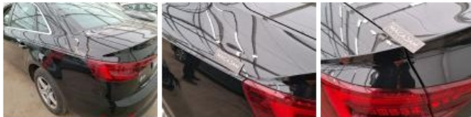
Aile ARD, Mauvaise réparation, Peindre
