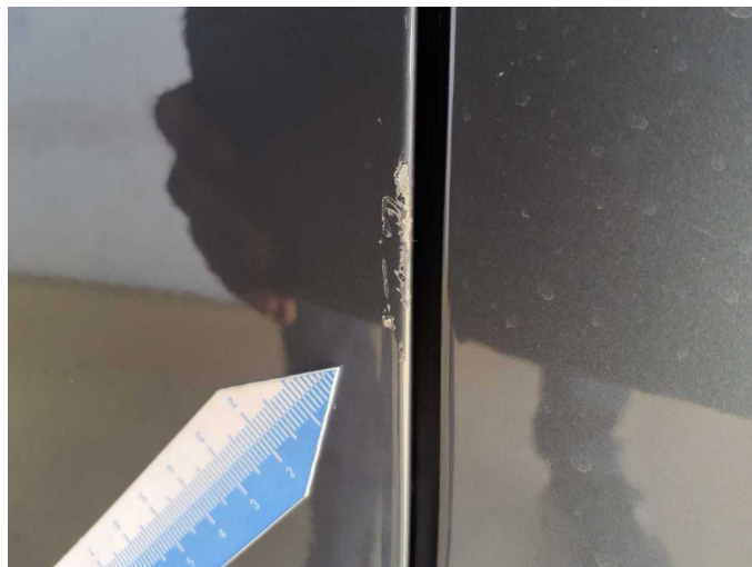
Beschädigung 8: Tür vorn links: Tür - Kratzer - lackieren
