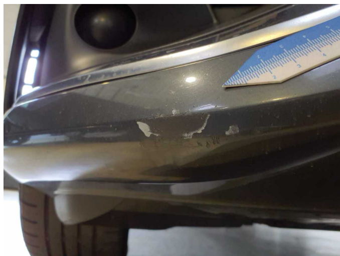
Beschädigung 13: Stossfänger vorn: Stossfänger vorn - Kratzer - lackieren
