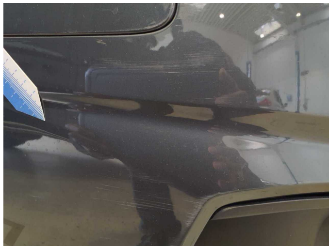
Beschädigung 13: Stossfänger vorn: Stossfänger vorn - Kratzer - lackieren
