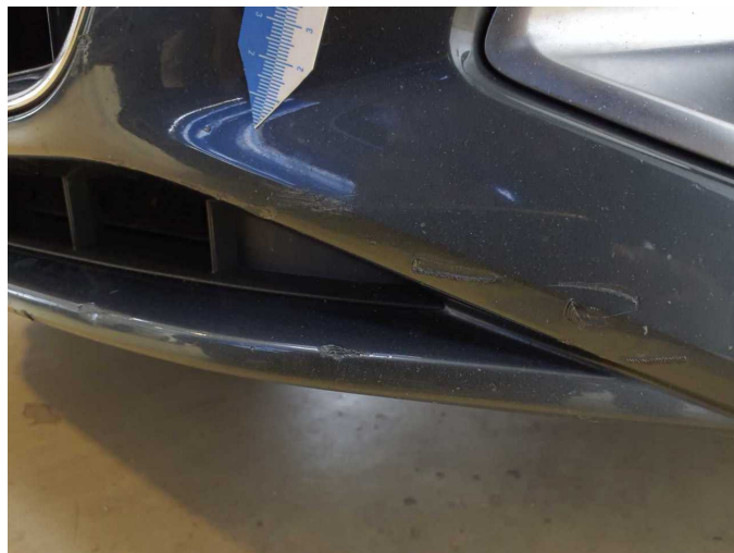
Beschädigung 13: Stossfänger vorn: Stossfänger vorn - Kratzer - lackieren
