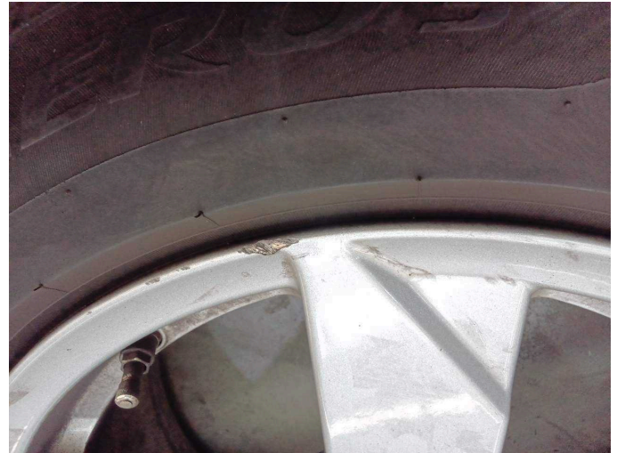
Beschädigung 5: 2.Radsatz: 1 Leichtmetallfelge - verkratzt / verschürft - Wertminderung
