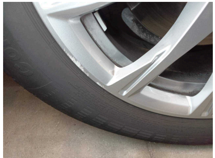
Beschädigung 4: Rad/Reifen: Leichtmetallfelge vorn rechts - verkratzt / verschürft - Smart Repair
