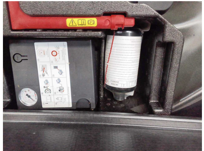
Beschädigung 1: Ausrüstung: Tirefit Füllmittel - abgelaufen - erneuern
