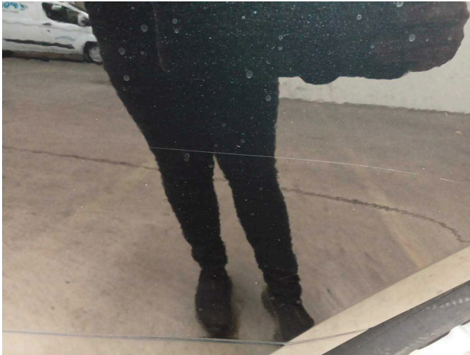
Beschädigung 7: Seitenwand rechts: Seitenwand - Kratzer - lackieren
