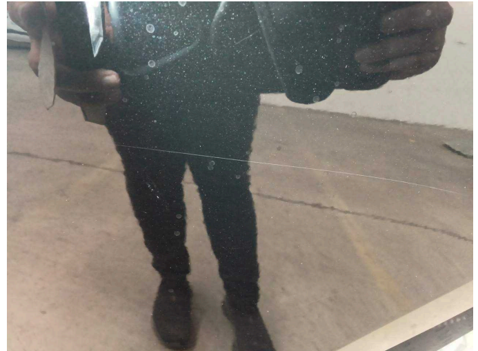
Beschädigung 7: Seitenwand rechts: Seitenwand - Kratzer - lackieren
