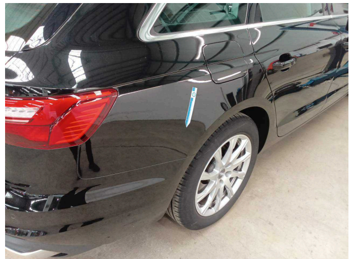
Beschädigung 7: Seitenwand rechts: Seitenwand - Kratzer - lackieren
