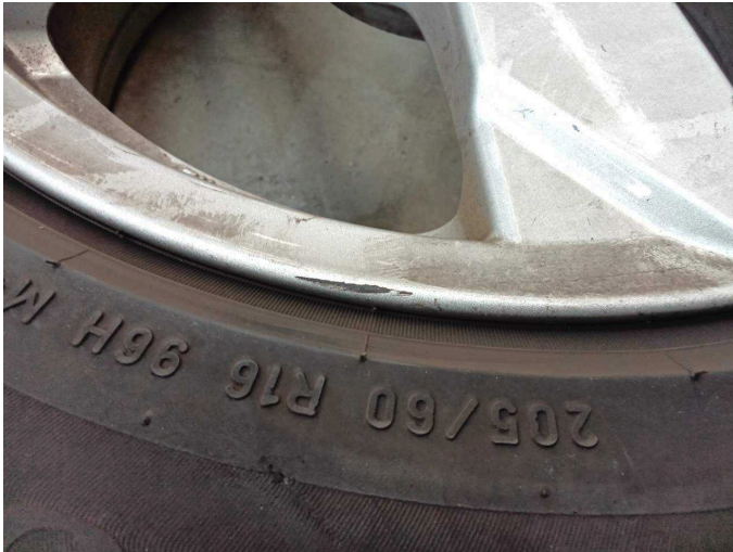
Beschädigung 5: 2.Radsatz: 1 Leichtmetallfelge - verkratzt / verschürft - Wertminderung
