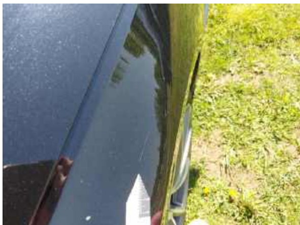
Bild 27: Kotflügel links - Kratzer
