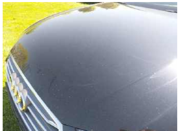
Bild 40: Frontbereich allgemein - kleine Steinschläge, große Steinschläge
