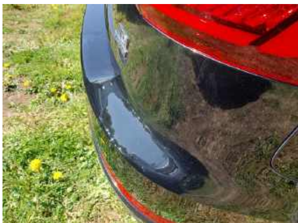
Bild 31: Stoßfänger hinten rechts - Kratzer
