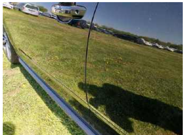
Bild 28: Türkantenanschlagspuren vorne links - Kratzer
