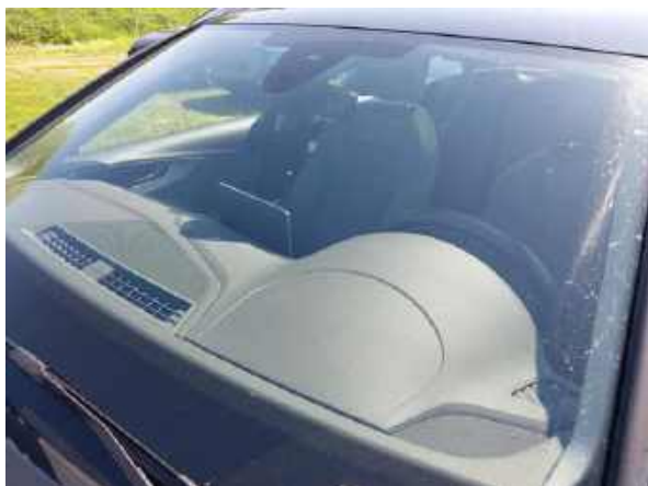
Bild 39: Windschutzscheibe - kleine Steinschläge
