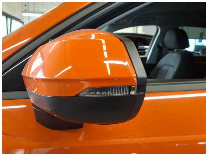
Beschädigung 2: Außenspiegel links: Abdeckkappe - Kratzer - Smart Repair
