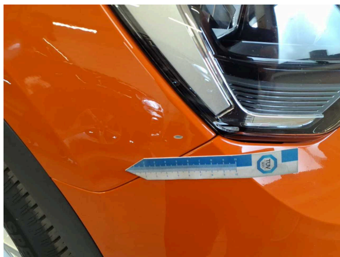
Beschädigung 7: Kotflügel rechts: Kotflügel rechts - Kratzer - lackieren
