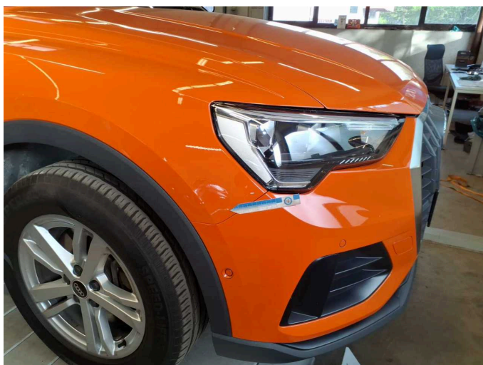
Beschädigung 7: Kotflügel rechts: Kotflügel rechts - Kratzer - lackieren
