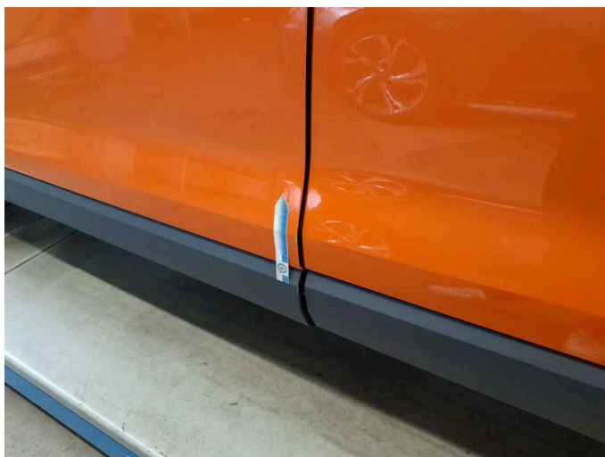
Beschädigung 3: Tür vorn links: Türkante - Kratzer - Smart Repair
