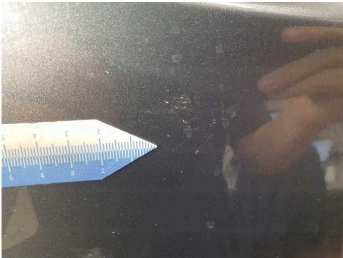
Beschädigung 4: Stossfänger vorn: Stossfänger vorn - Kratzer - lackieren
