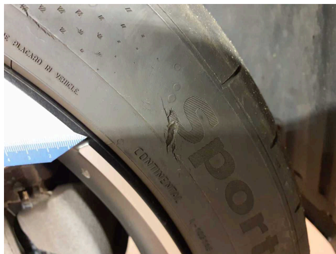
Beschädigung 3: Rad/Reifen: Reifen vorn rechts (nicht fahrbereit) - beschädigt - erneuern
