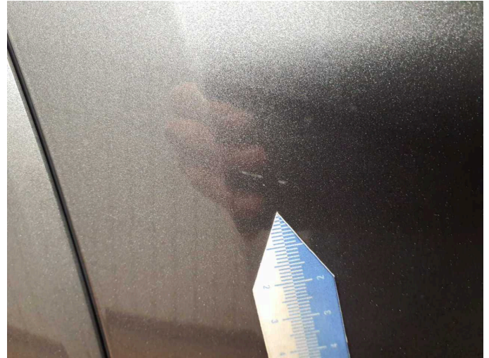
Beschädigung 4: Stossfänger vorn: Stossfänger vorn - Kratzer - lackieren
