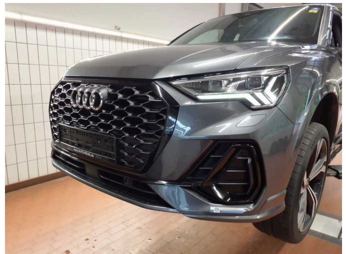
Beschädigung 4: Stossfänger vorn: Stossfänger vorn - Kratzer - lackieren
