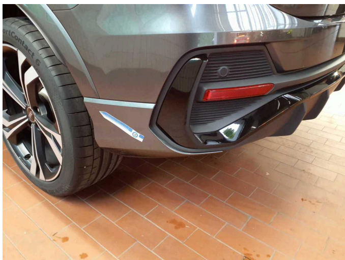
Beschädigung 2: Stossfänger hinten: Spoiler - Kratzer - Smart Repair
