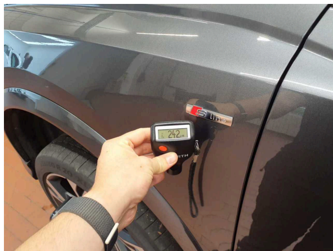
Nachlackierung 3: Kotflügel links
