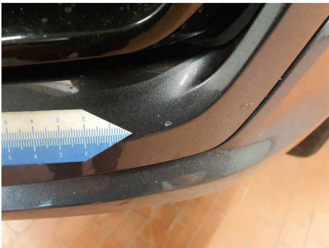
Beschädigung 4: Stossfänger vorn: Stossfänger vorn - Kratzer - lackieren
