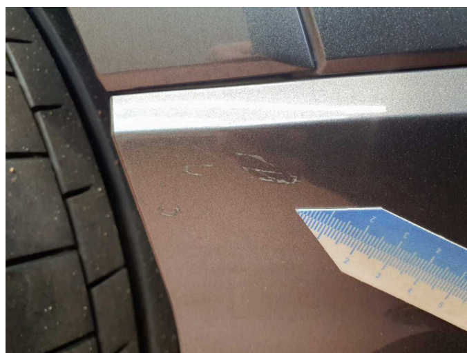
Beschädigung 2: Stossfänger hinten: Spoiler - Kratzer - Smart Repair
