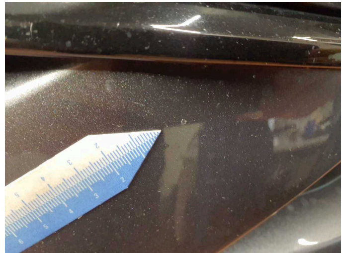
Beschädigung 4: Stossfänger vorn: Stossfänger vorn - Kratzer - lackieren
