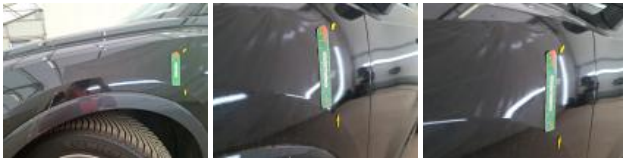
Porte AVG, Mauvaise réparation, Peindre
