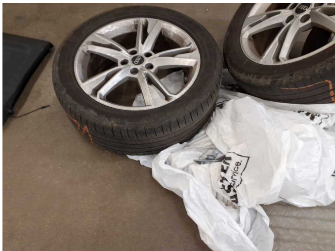
Beschädigung 3: 2.Radsatz: 2 Reifen (2mm) - entspricht nicht den Leasingvorgaben - erneuern
