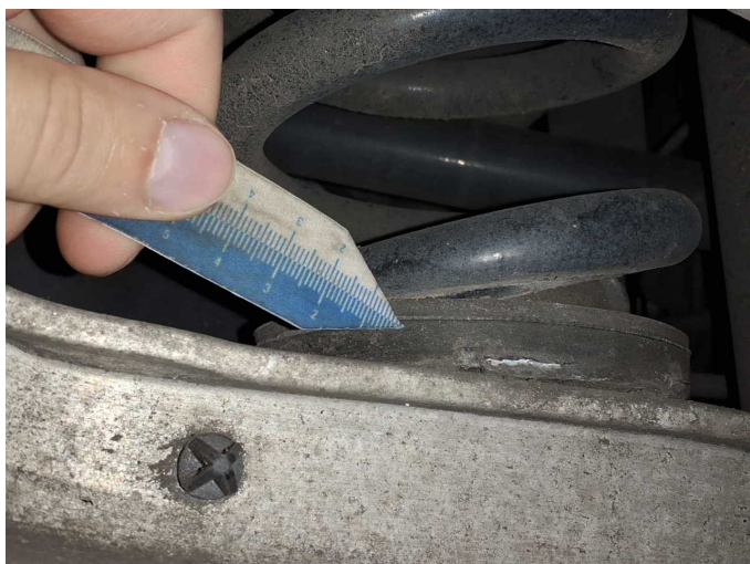
Beschädigung 5: Hinterachse: Feder rechts - verschlissen - erneuern
