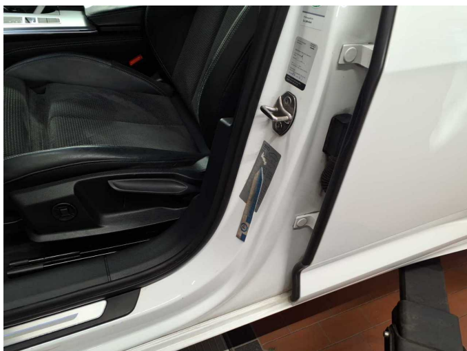
Beschädigung 3: Schweller links: Einstieg (+ Aufkleber Reifendruck) - Delle / Lackschaden - Smart Repair
