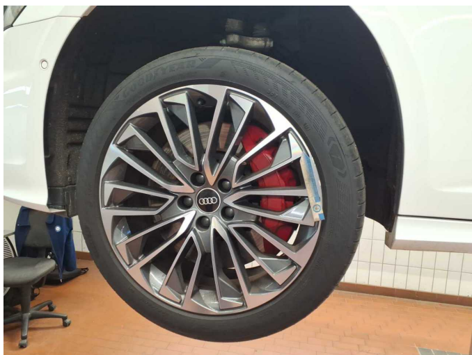
Beschädigung 4: Rad/Reifen: Leichtmetallfelge vorn links (Materialabtrag, Optischer Mangel) - verkratzt / verschürft - Wertminderung
