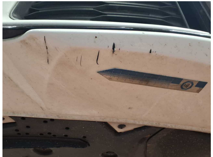
Beschädigung 7: Stossfänger vorn: Stossfänger vorn (Unterhalb) - verkratzt / verschürft - lackieren
