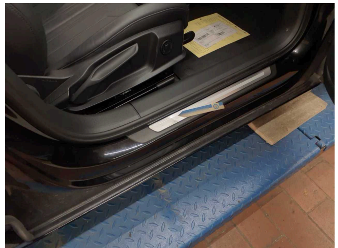
Damage 3: Sill - right side: Sill (Verkleidung) - dent(s) - Replace
