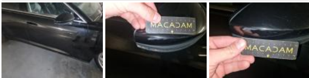
Door RR, Scratch(es), Acceptable
