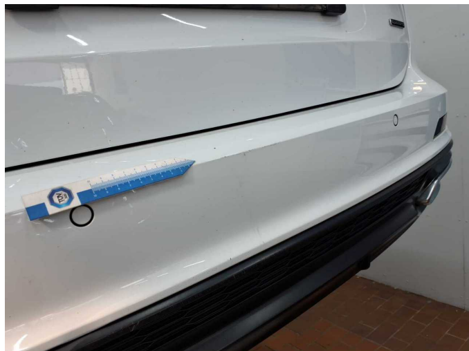
Beschädigung 11: Stossfänger hinten: Stossfänger hinten - beschädigt - erneuern
