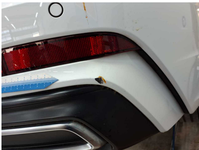
Beschädigung 11: Stossfänger hinten: Stossfänger hinten - beschädigt - erneuern
