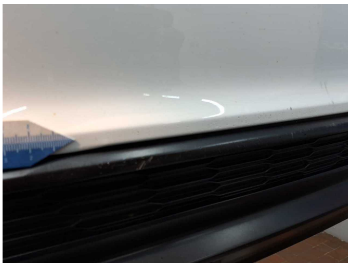
Beschädigung 11: Stossfänger hinten: Stossfänger hinten - beschädigt - erneuern
