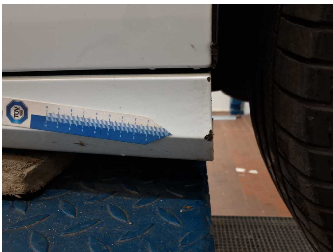
Beschädigung 5: Schweller rechts: Schweller - verkratzt / verschürft - lackieren
