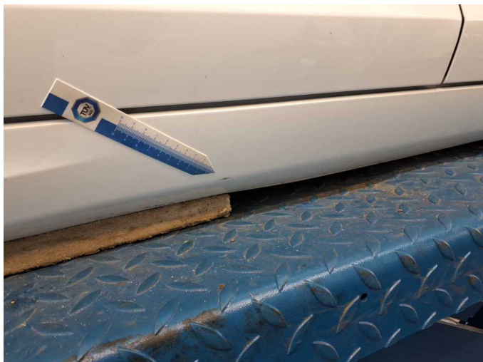
Beschädigung 5: Schweller rechts: Schweller - verkratzt / verschürft - lackieren
