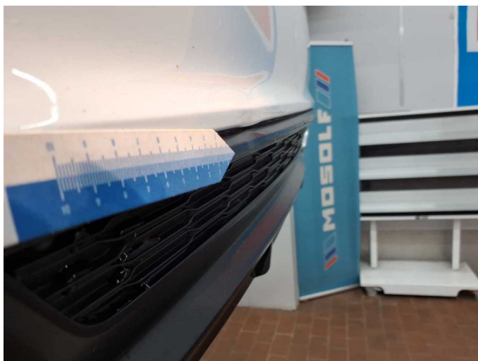
Beschädigung 4: Stossfänger hinten: Spoiler - beschädigt - erneuern
