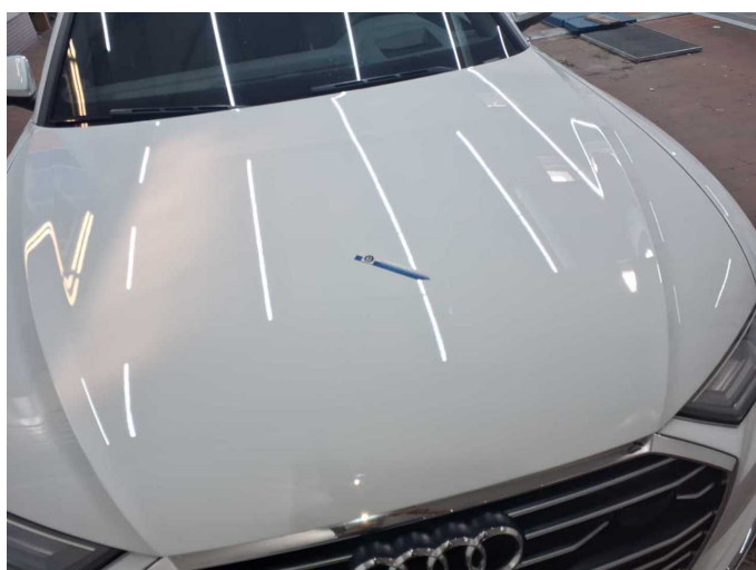
Beschädigung 2: Motorhaube: Motorhaube - Steinschlag - Smart Repair
