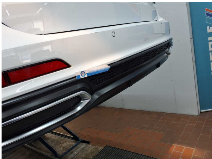
Beschädigung 4: Stossfänger hinten: Spoiler - beschädigt - erneuern
