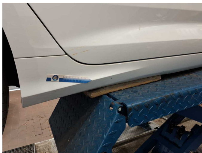
Beschädigung 5: Schweller rechts: Schweller - verkratzt / verschürft - lackieren
