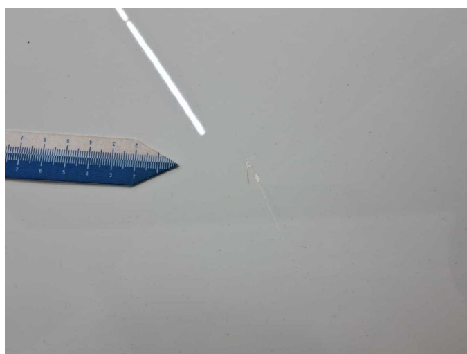
Beschädigung 2: Motorhaube: Motorhaube - Steinschlag - Smart Repair
