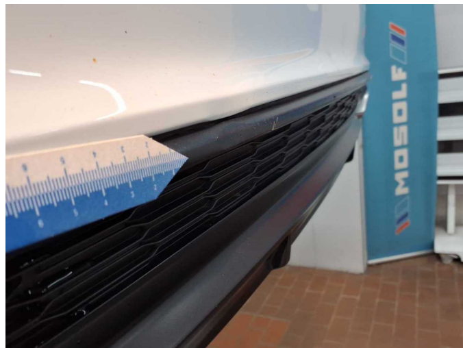
Beschädigung 4: Stossfänger hinten: Spoiler - beschädigt - erneuern
