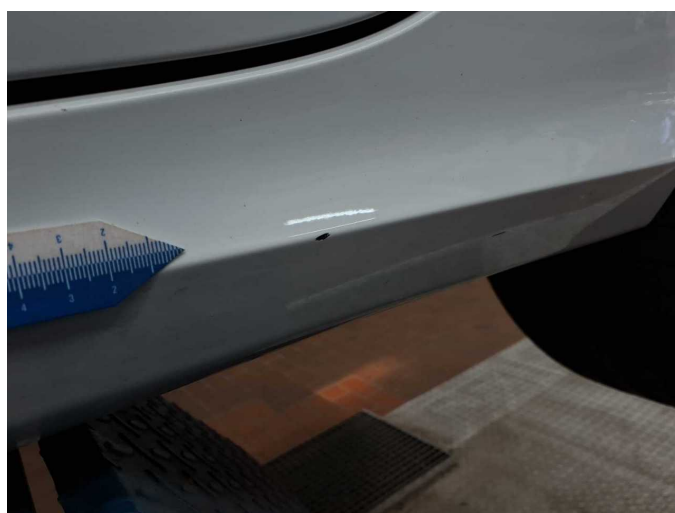
Beschädigung 1: Schweller links: Schweller - verkratzt / verschürft - Smart Repair
