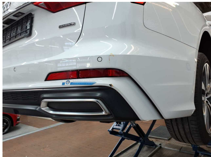
Beschädigung 11: Stossfänger hinten: Stossfänger hinten - beschädigt - erneuern
