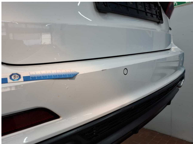
Beschädigung 11: Stossfänger hinten: Stossfänger hinten - beschädigt - erneuern
