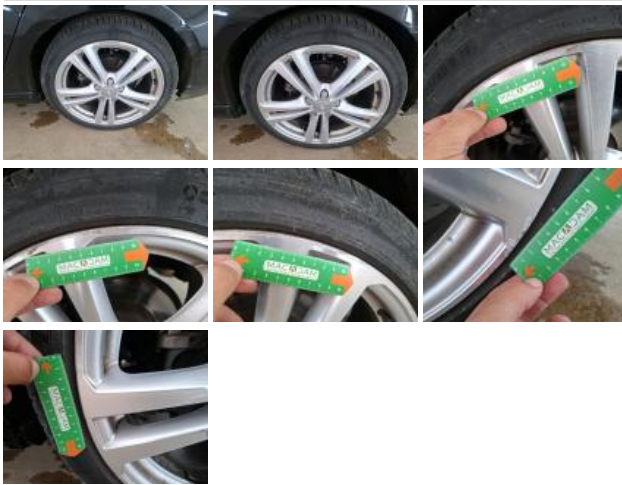
Pneu ARG, Déchirure, E - Remplacer
