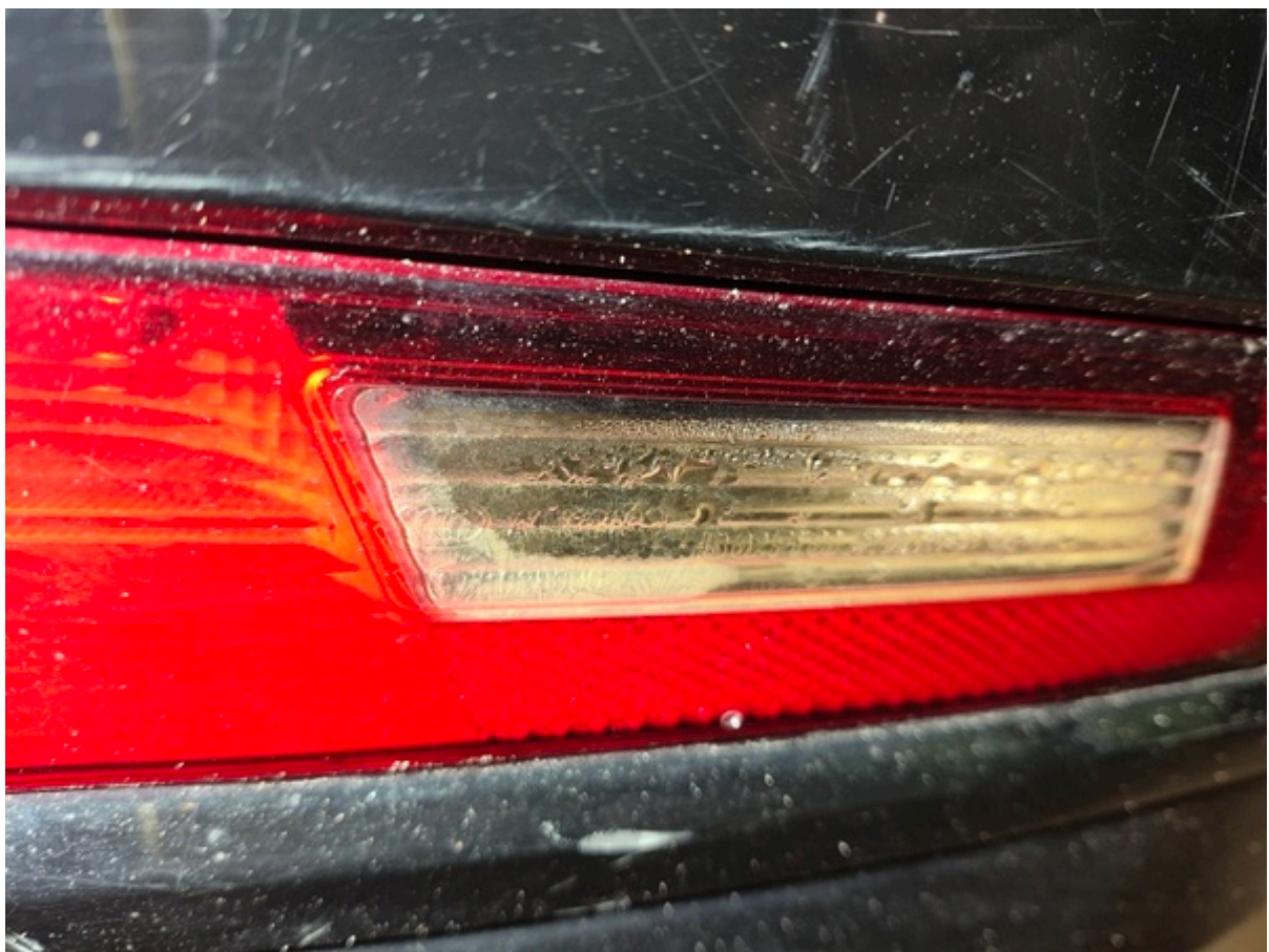
Övrigt Övrigt Reflex glaset höger bak fukt samt att lampan lyser ej
