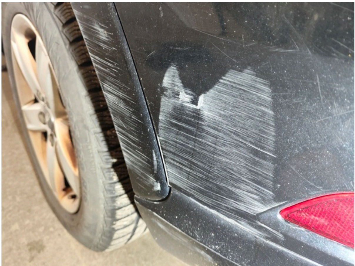
Stötfångare bak 1 Skada Lackering Skrap 5 638 kr
