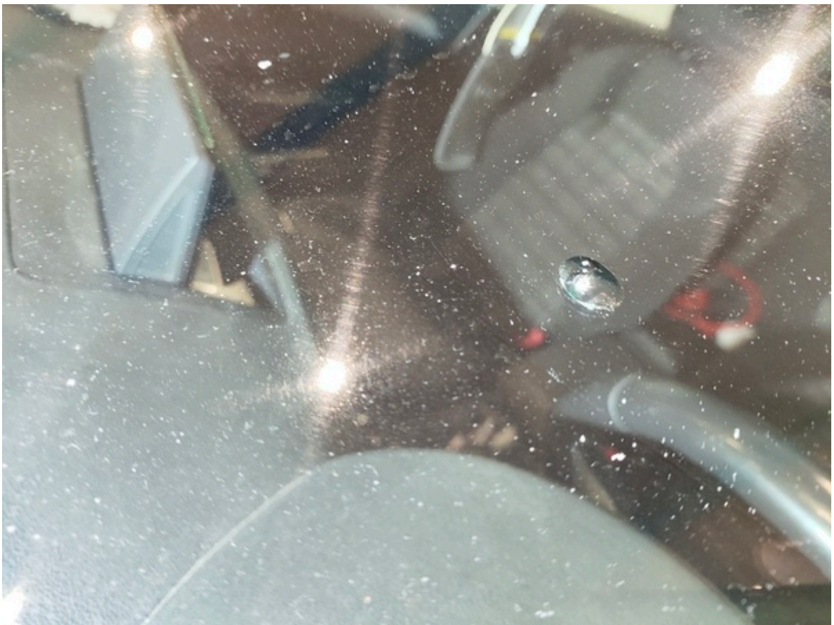
Vindruta byte Flertal stenscott med sprickor 11 935 kr
