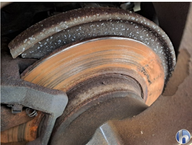
14. Bremse Komplett Hinten fehlt der Belag
