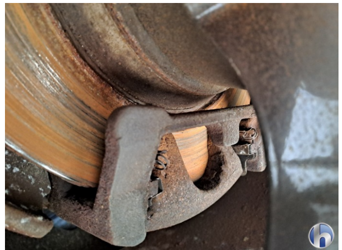
14. Bremse Komplett Hinten fehlt der Belag
