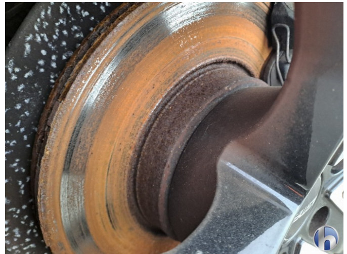
14. Bremse Komplett Hinten fehlt der Belag
