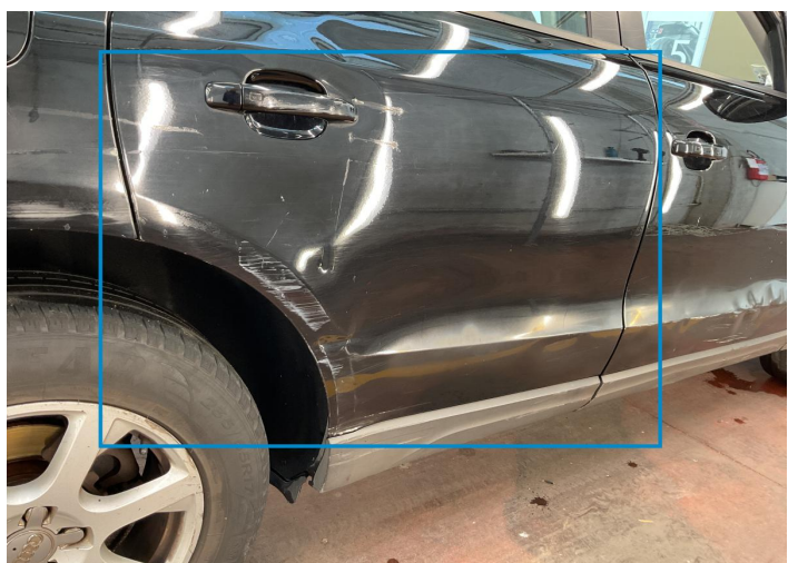
25. Door / Back Right Bodywork / Dent -
