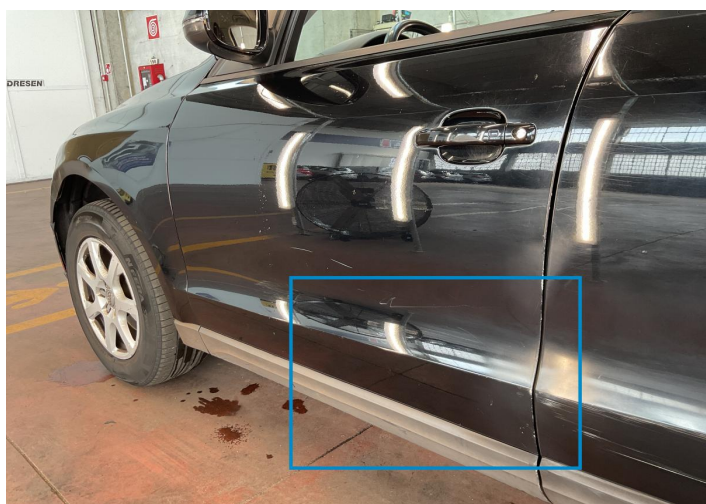
13. Door / Front Left Bodywork / Dent -
