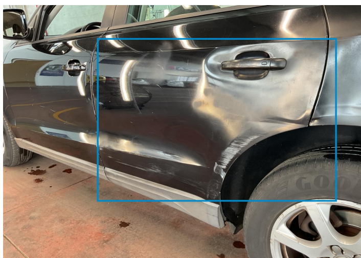
15. Door / Back Left Bodywork / Dent -
