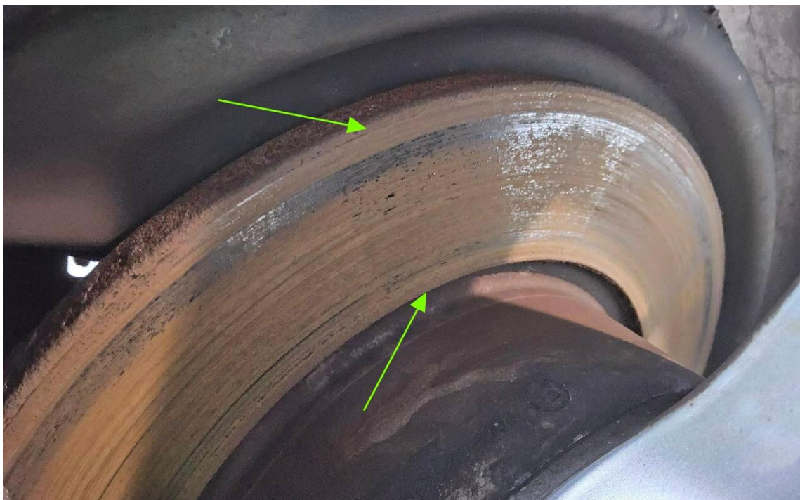
Bild 18 : Bremse vorne und hinten starke Korrosionsbildung
