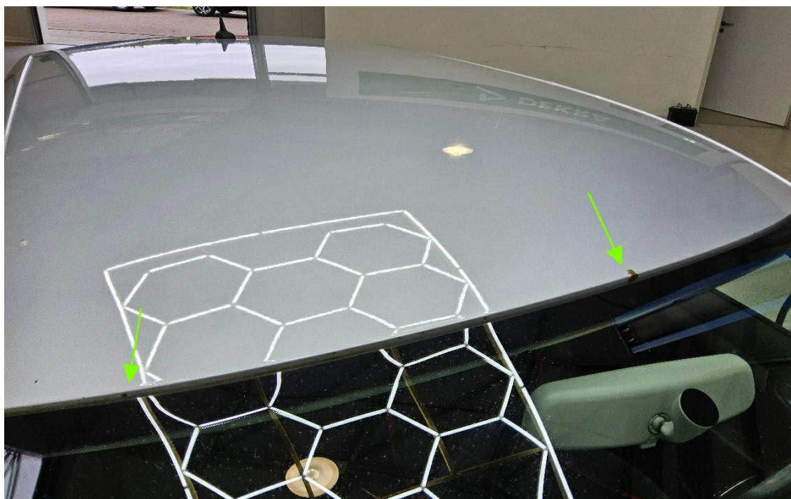
Bild 12 : Dach Steinschlag mit Korrosionsbildung
