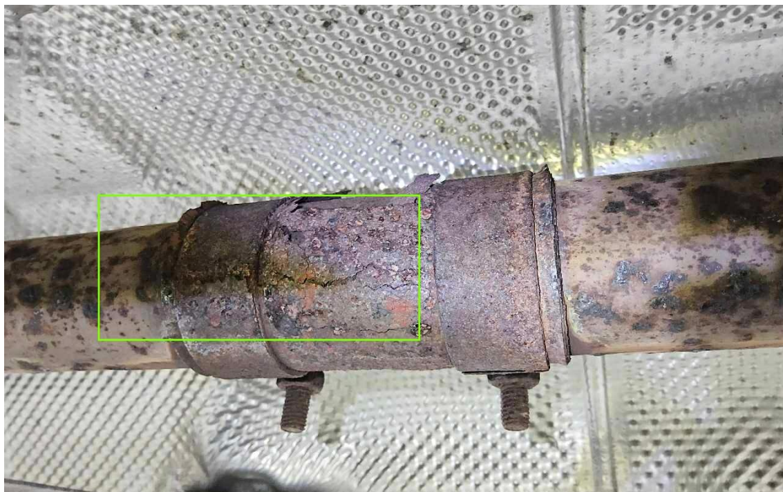
Bild 16 : Rohrverbinder Abgasanlage gebrochen
