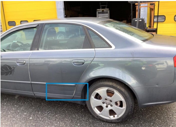
6. Door / Back Left Bodywork / Dent / Dent -
