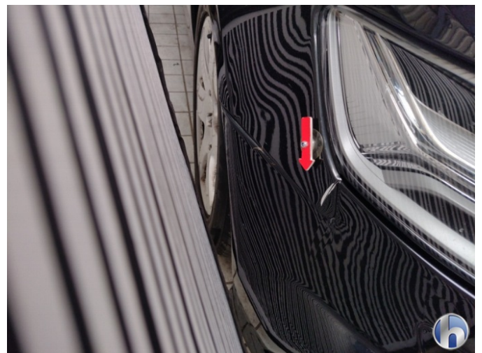
16. Unfallschaden Vorne Rechts Schadenserweiterung
