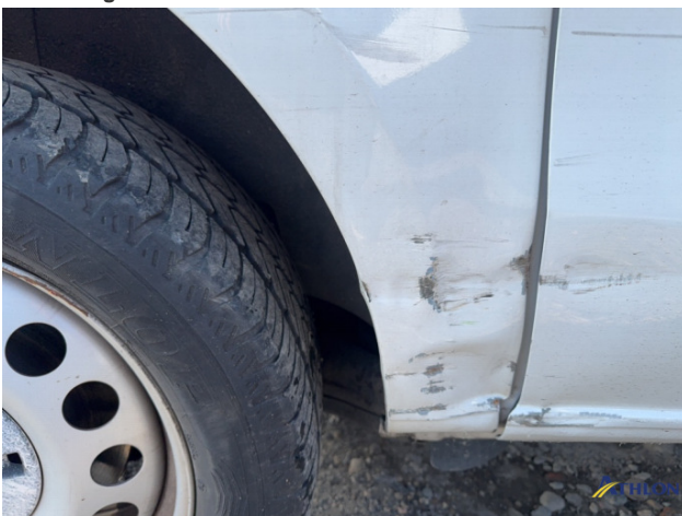
11. parete laterale - posteriore - destra Ammaccature/rigonfiamenti
