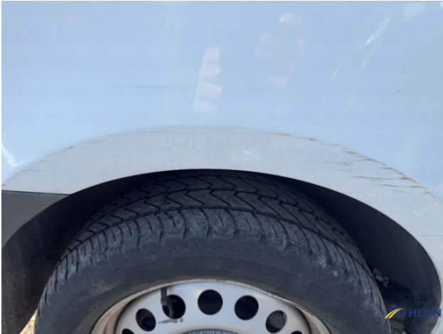
11. parete laterale - posteriore - destra Ammaccature/rigonfiamenti
