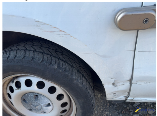
11. parete laterale - posteriore - destra Ammaccature/rigonfiamenti
