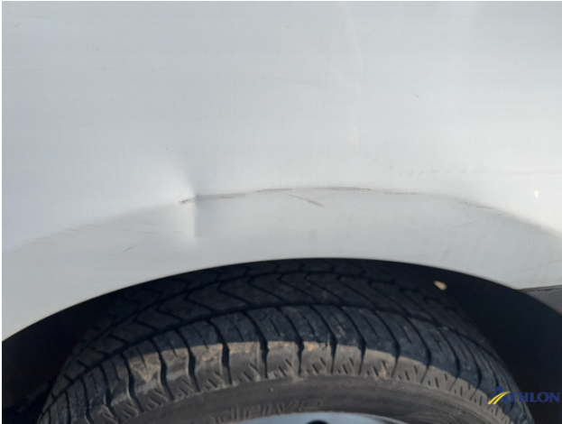
8. parete laterale - posteriore - sinistra Ammaccature/rigonfiamenti
