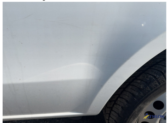
8. parete laterale - posteriore - sinistra Ammaccature/rigonfiamenti
