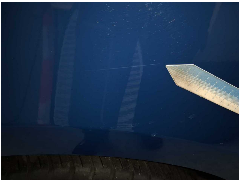
Beschädigung #6: Seitenwand rechts: Seitenwand - Kratzer - lackieren
