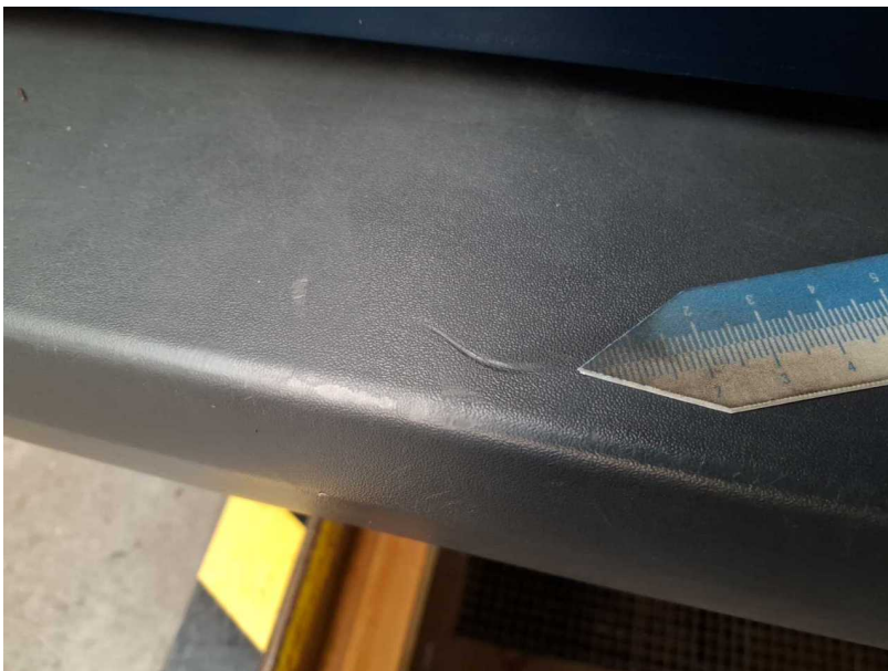
Beschädigung #7: Stossfänger hinten: Stossfänger mit Parktronic - verkratzt / verschürft - erneuern
