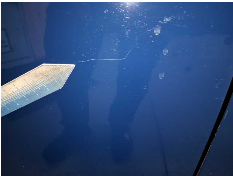
Beschädigung #4: Schiebetür rechts: Schiebetür mit Glasscheibe - Kratzer - lackieren
