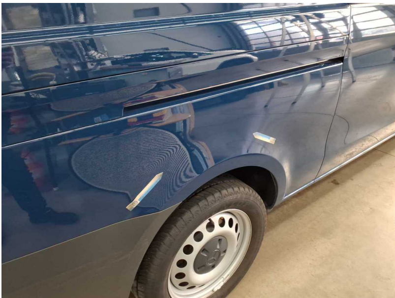
Beschädigung #6: Seitenwand rechts: Seitenwand - Kratzer - lackieren
