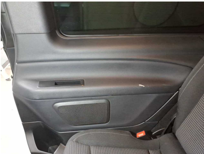
Beschädigung #21: Verkleidungen/Abdeckungen: Laderaumverkleidung rechts - gebrochen / gerissen - erneuern
