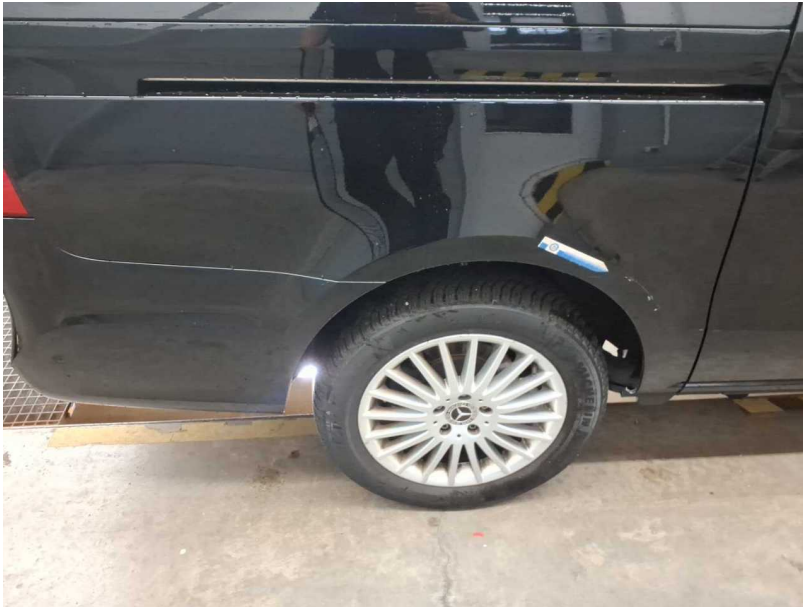
Beschädigung #13: Seitenwand rechts: Seitenwand - verkratzt / verschürft - lackieren
