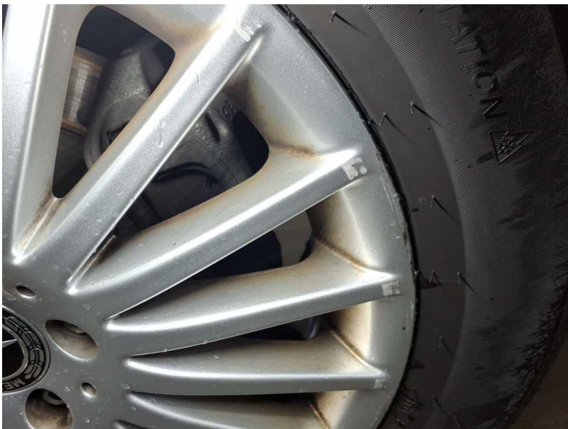
Beschädigung #11: Rad/Reifen: Leichtmetallfelge hinten links - verkratzt / verschürft - erneuern
