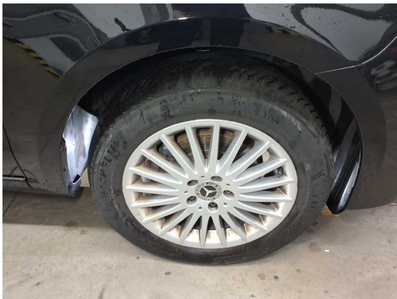
Beschädigung #6: Rad/Reifen: Reifen vorn - verschlissen - erneuern
