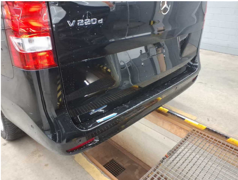
Beschädigung #5: Stossfänger hinten: Stossfänger mit Parktronic - verkratzt / verschürft - lackieren
