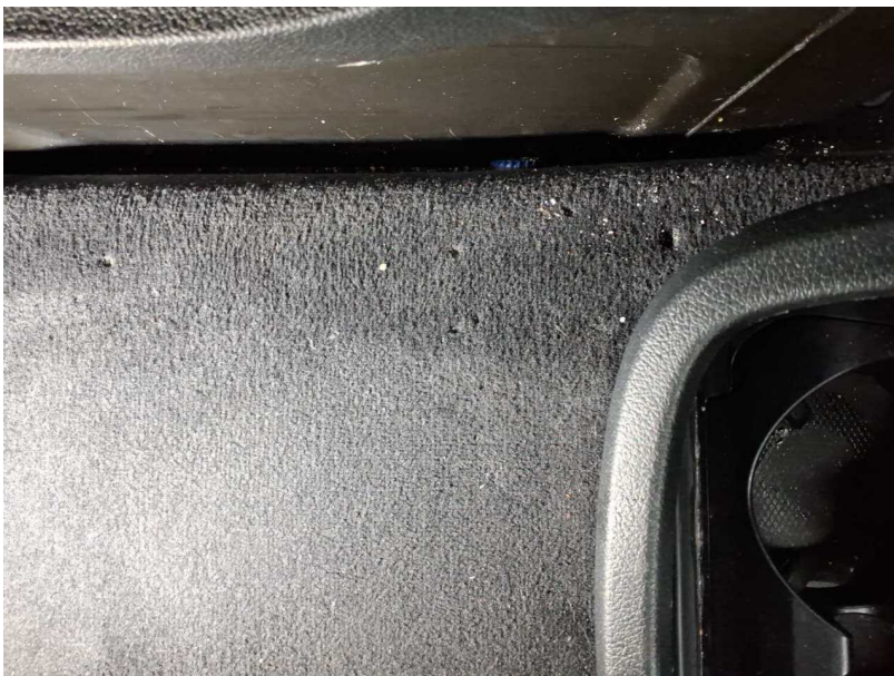
Beschädigung #18: Verkleidungen/Abdeckungen: Teppichboden (vorn) - Brandloch - erneuern
