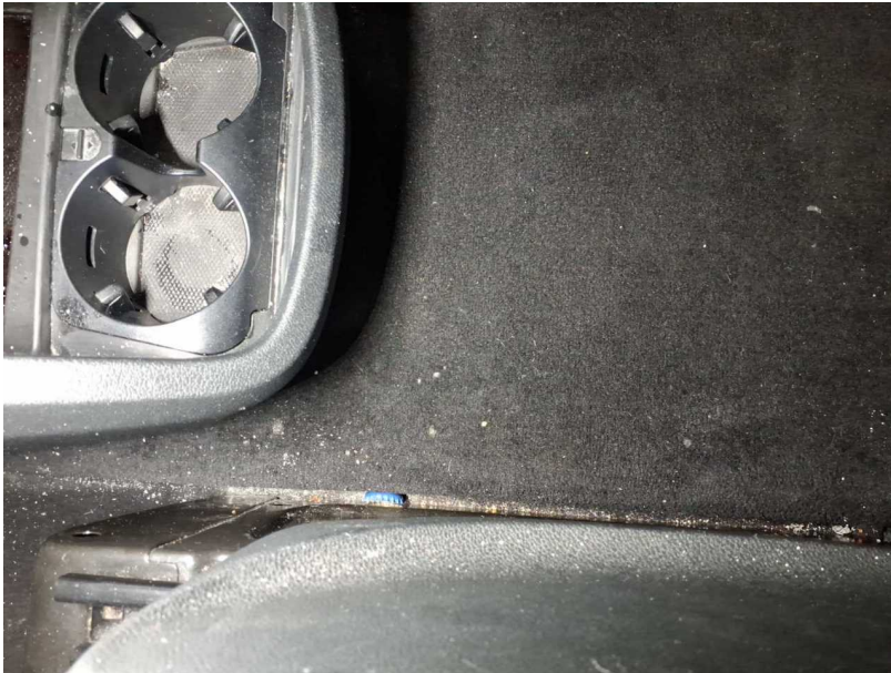
Beschädigung #18: Verkleidungen/Abdeckungen: Teppichboden (vorn) - Brandloch - erneuern
