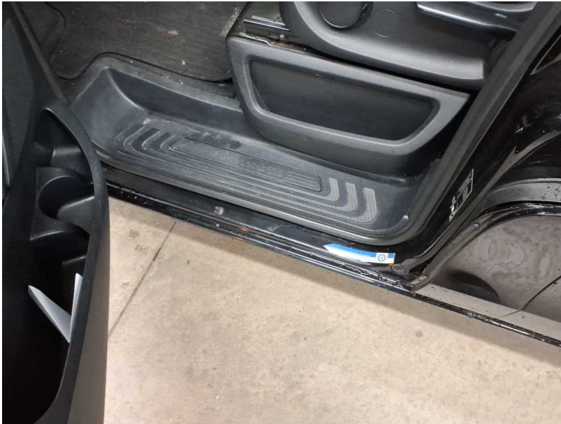
Beschädigung #7: Schweller links: Einstieg - verkratzt / verschürft - lackieren
