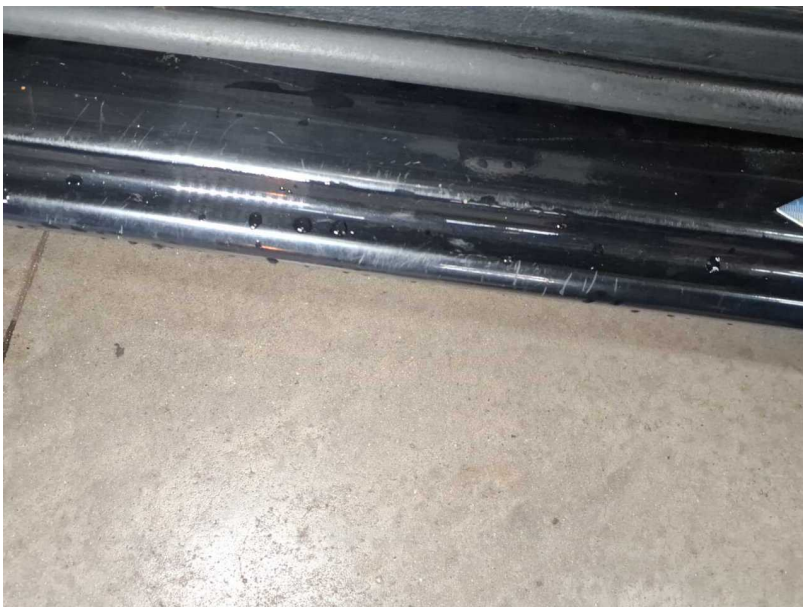
Beschädigung #7: Schweller links: Einstieg - verkratzt / verschürft - lackieren
