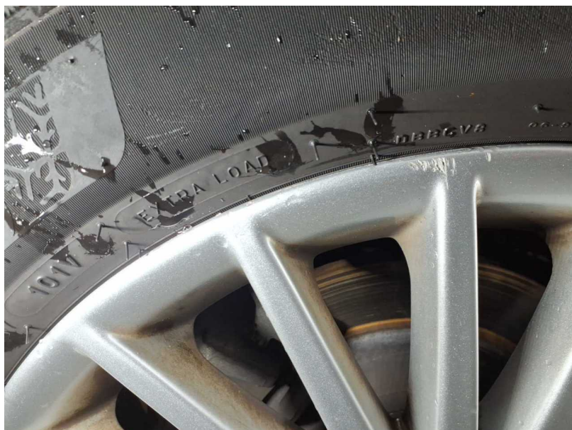
Beschädigung #10: Rad/Reifen: Leichtmetallfelge hinten rechts - verkratzt / verschürft - erneuern
