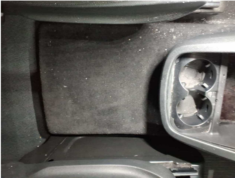
Beschädigung #18: Verkleidungen/Abdeckungen: Teppichboden (vorn) - Brandloch - erneuern
