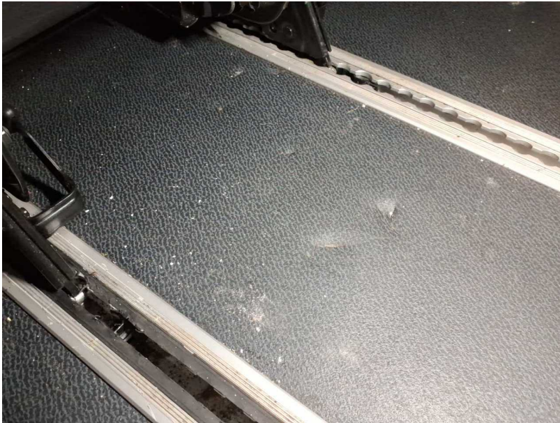
Beschädigung #20: Interieur: Laderaumboden - gebrochen / gerissen - erneuern
