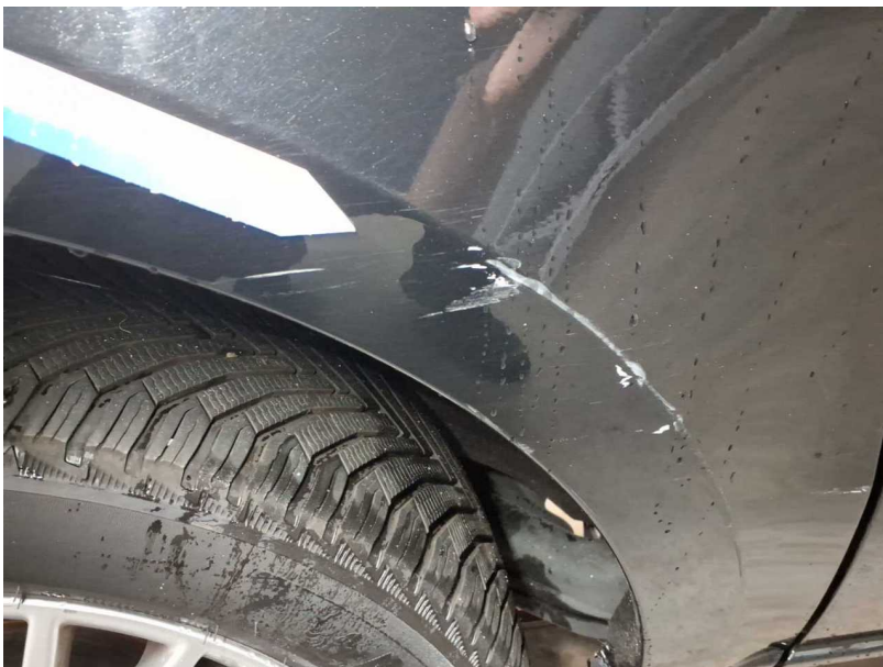
Beschädigung #13: Seitenwand rechts: Seitenwand - verkratzt / verschürft - lackieren
