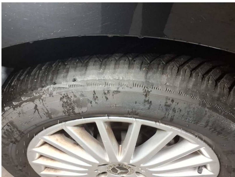
Beschädigung #6: Rad/Reifen: Reifen vorn - verschlissen - erneuern
