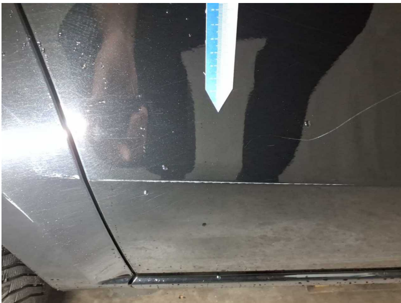
Beschädigung #12: Schiebetür rechts: Schiebetür - verkratzt / verschürft - lackieren
