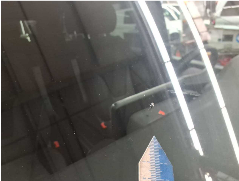
Beschädigung #19: Verglasung: Frontscheibe - gebrochen / gerissen - erneuern
