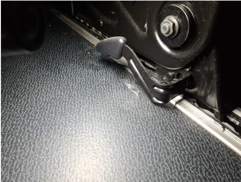
Beschädigung #20: Interieur: Laderaumboden - gebrochen / gerissen - erneuern
