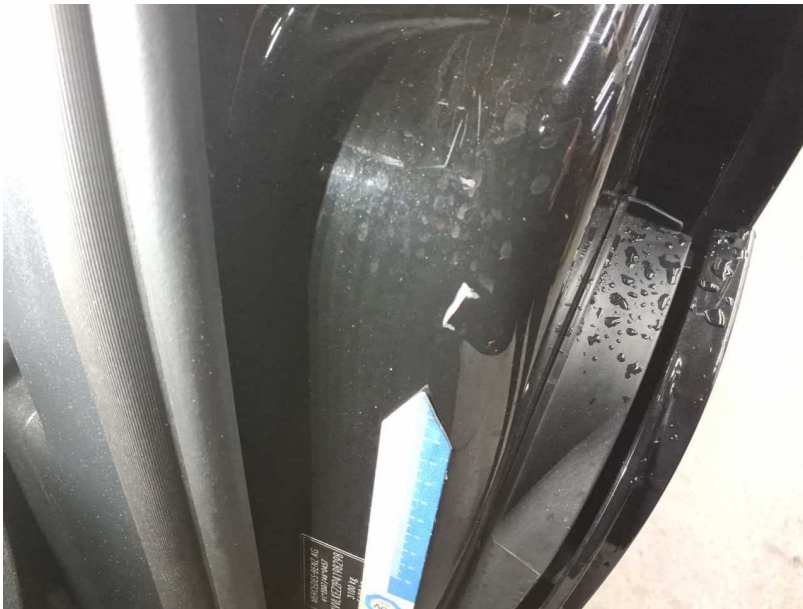
Beschädigung #7: Schweller links: Einstieg - verkratzt / verschürft - lackieren
