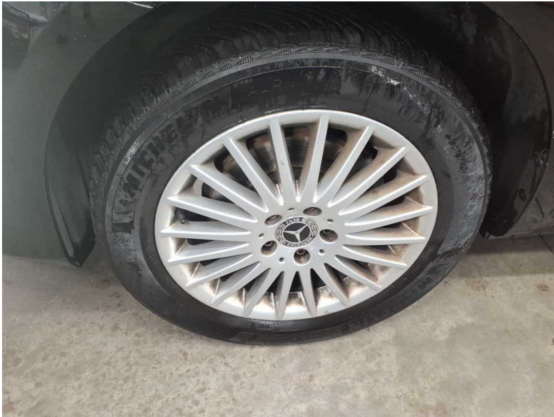
Beschädigung #6: Rad/Reifen: Reifen vorn - verschlissen - erneuern
