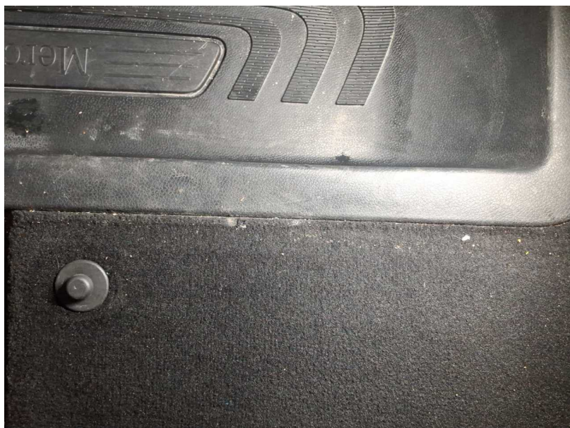
Beschädigung #18: Verkleidungen/Abdeckungen: Teppichboden (vorn) - Brandloch - erneuern
