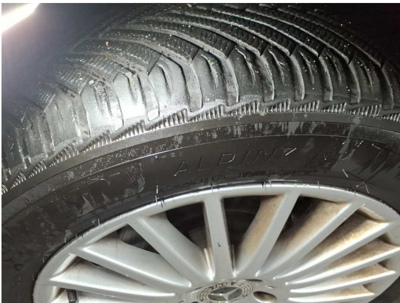
Beschädigung #6: Rad/Reifen: Reifen vorn - verschlissen - erneuern
