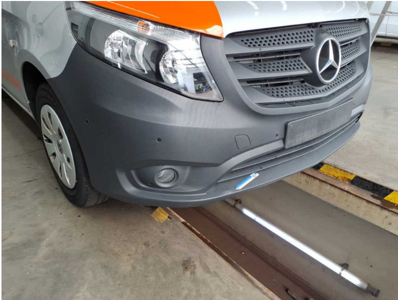
Beschädigung #7: Stossfänger vorn: Stossfänger mit Parktronic - verformt - erneuern
