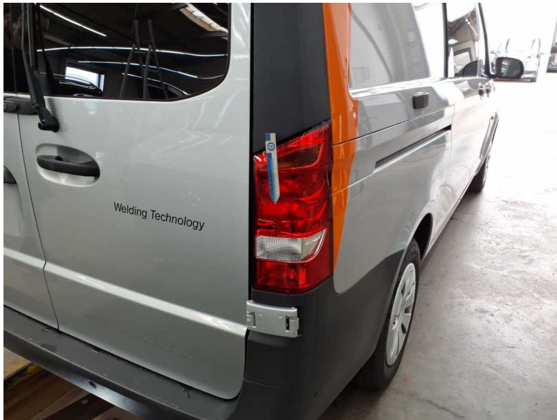
Beschädigung #3: Heckleuchte: Heckleuchte rechts - gebrochen / gerissen - erneuern
