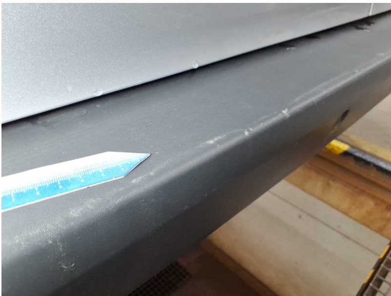
Beschädigung #6: Stossfänger hinten: Stossfänger mit Parktronic - verkratzt / verschürft - erneuern
