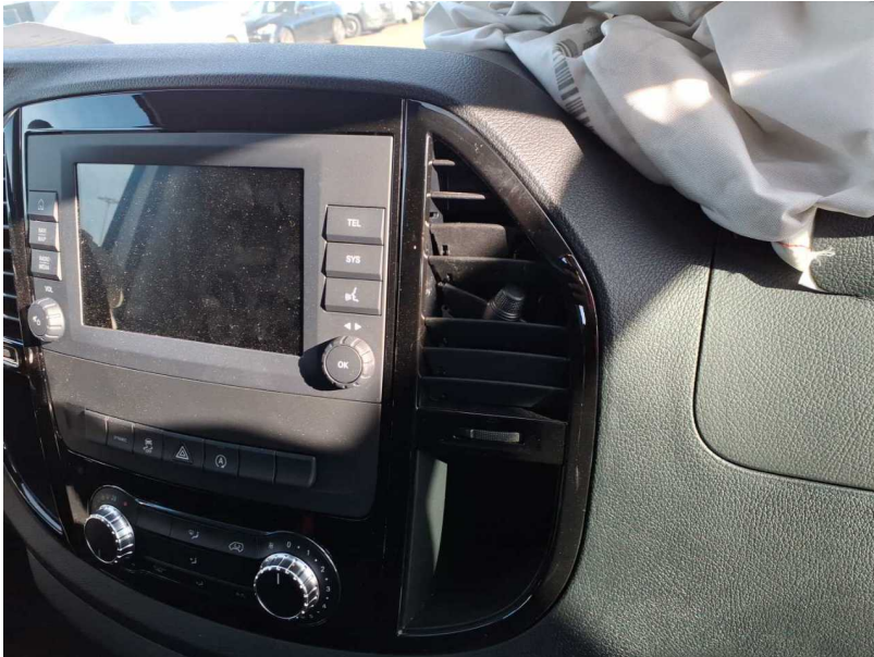
Beschädigung #1: Instrumententafel: Luftdüse Mitte (Rechts) - gebrochen / gerissen - erneuern
