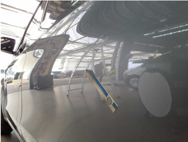
Beschädigung #14: Seitenwand links: Seitenwand - Delle / Lackschaden - instandsetzen und lackieren
