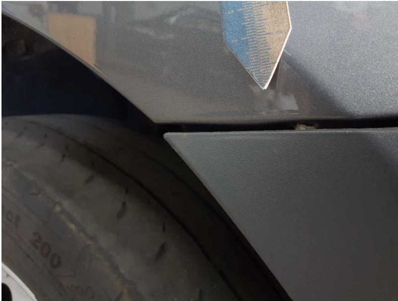
Beschädigung #9: Kotflügel rechts: Kotflügel rechts - Delle / Lackschaden - instandsetzen und lackieren
