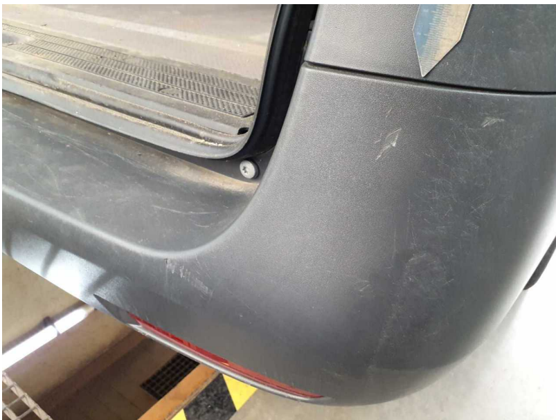
Beschädigung #11: Stossfänger hinten: Stossfänger hinten - beschädigt - erneuern
