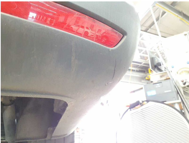
Beschädigung #11: Stossfänger hinten: Stossfänger hinten - beschädigt - erneuern
