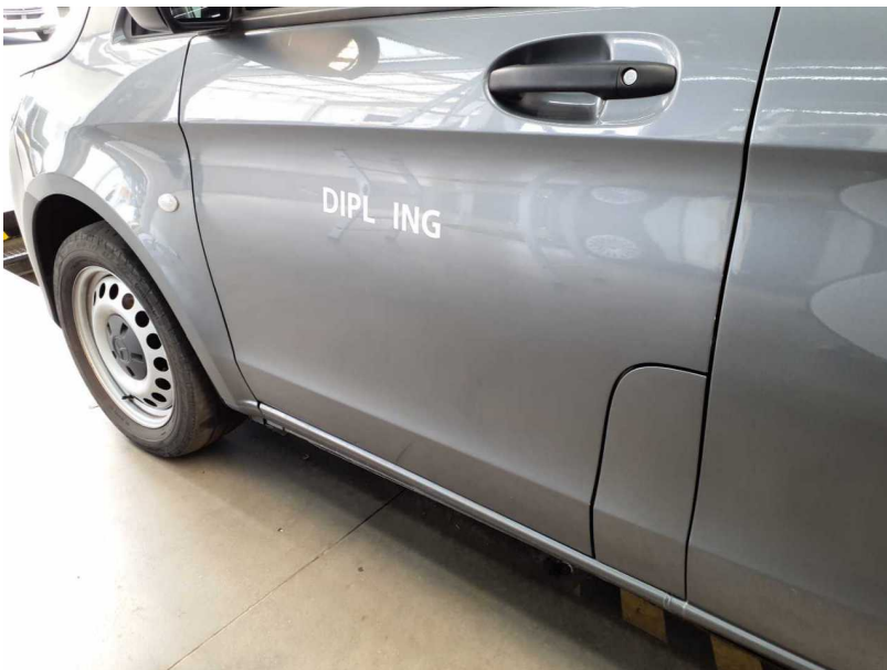
Gebrauchsspur #3: Tür vorn links: Tür - Delle / Lackschaden
