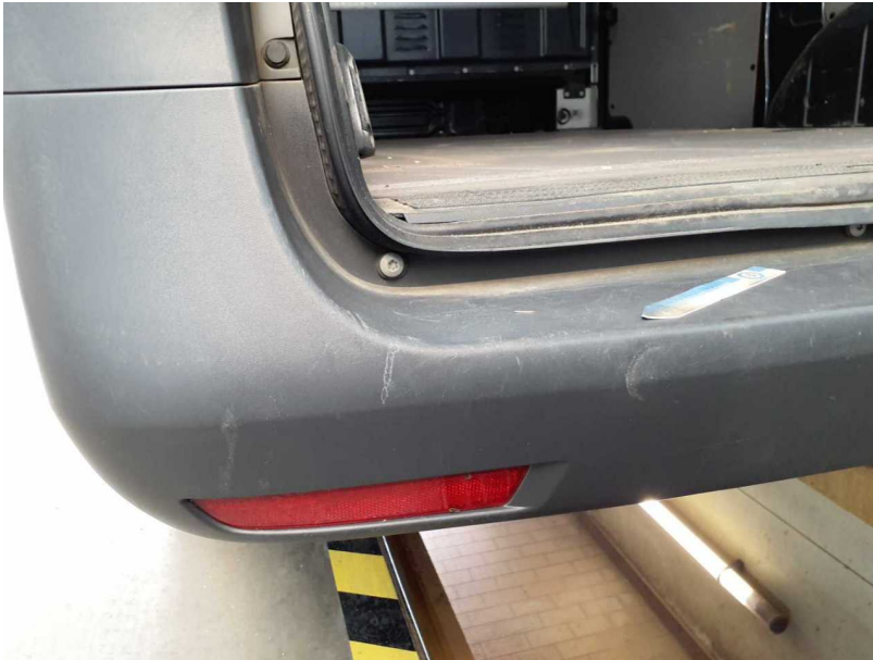
Beschädigung #11: Stossfänger hinten: Stossfänger hinten - beschädigt - erneuern
