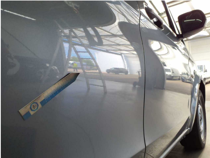
Beschädigung #3: Schiebetür rechts: Schiebetür - Delle(n) - Smart Repair
