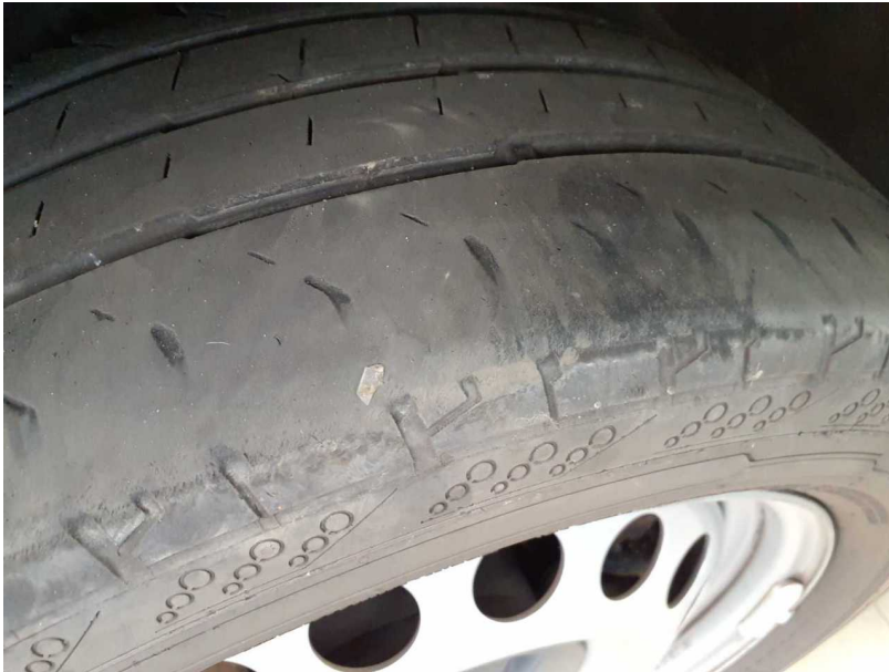
Beschädigung #8: Rad/Reifen: Reifen vorn - unvollständig - erneuern
