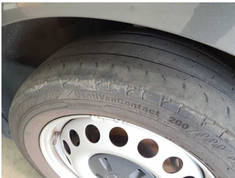
Beschädigung #8: Rad/Reifen: Reifen vorn - unvollständig - erneuern
