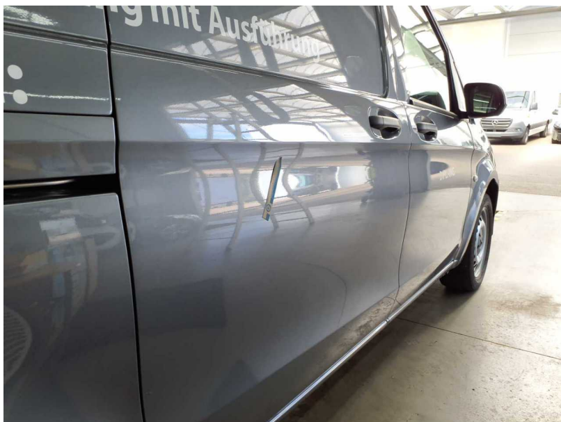
Beschädigung #3: Schiebetür rechts: Schiebetür - Delle(n) - Smart Repair
