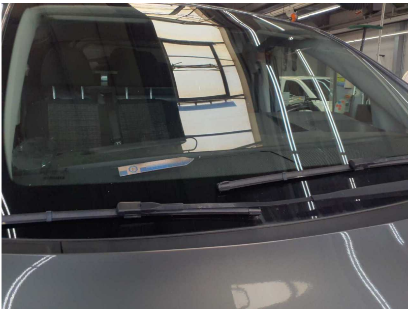
Beschädigung #15: Verglasung: Frontscheibe mit Spurhalteassistent - Steinschlag - erneuern
