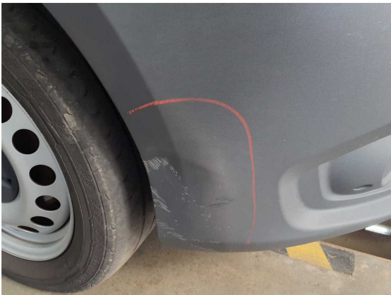
Beschädigung #10: Stossfänger vorn: Stossfänger vorn - beschädigt - erneuern
