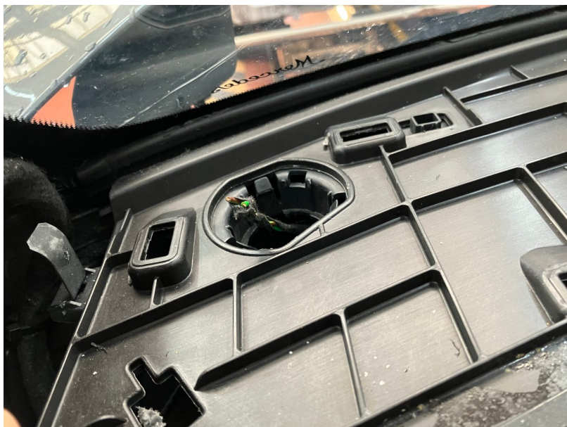
Beschädigung #7: Multimediasystem: Multimediasystem (Kabelsatz & Stecker für Hochtöner links & Hochtöner erneuern) - abweichend Auslieferungszustand - erneuern
