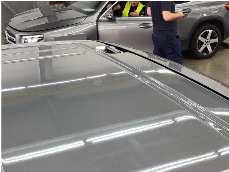
Beschädigung #5: Fahrzeugdach: Dach - Delle(n) - Smart Repair
