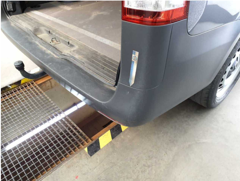
Beschädigung #11: Stossfänger hinten: Stossfänger hinten - beschädigt - erneuern
