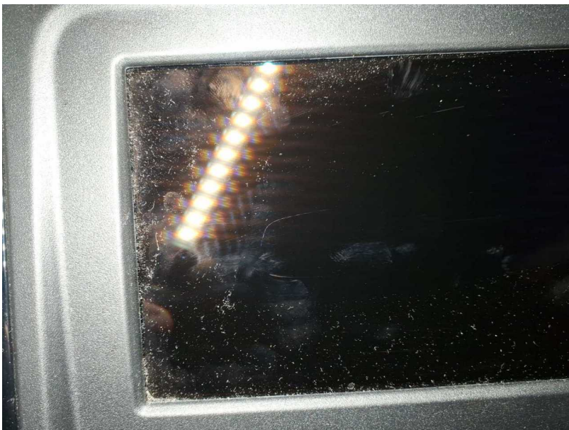
Beschädigung #4: Multimediasystem: Radio - Kratzer - erneuern
