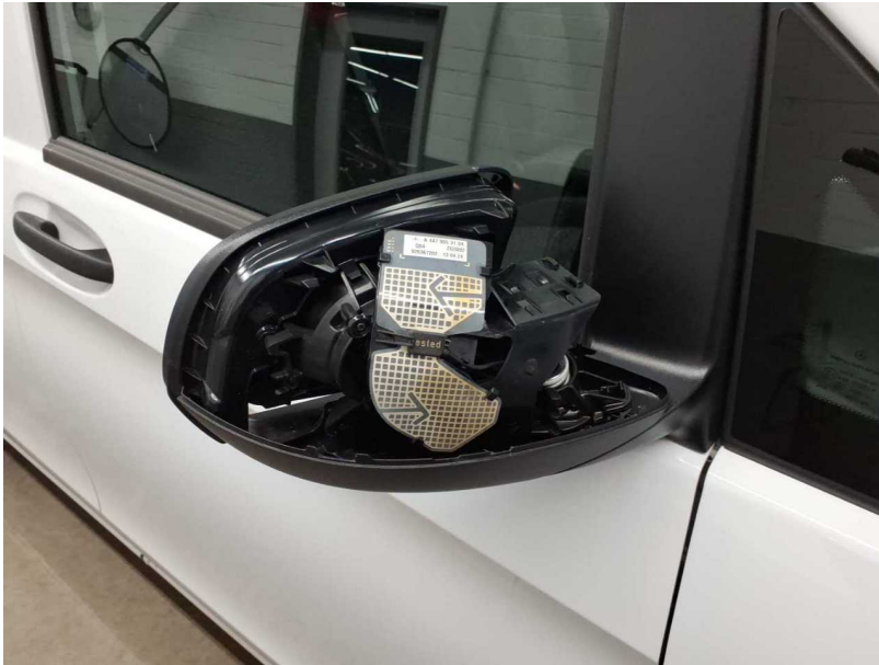
Beschädigung #3: Außenspiegel rechts: Spiegelgehäuse (Spiegelkappe fehlt) - gebrochen / gerissen - erneuern
