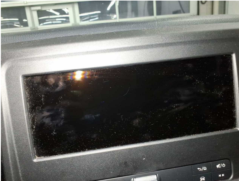
Beschädigung #4: Multimediasystem: Radio - Kratzer - erneuern
