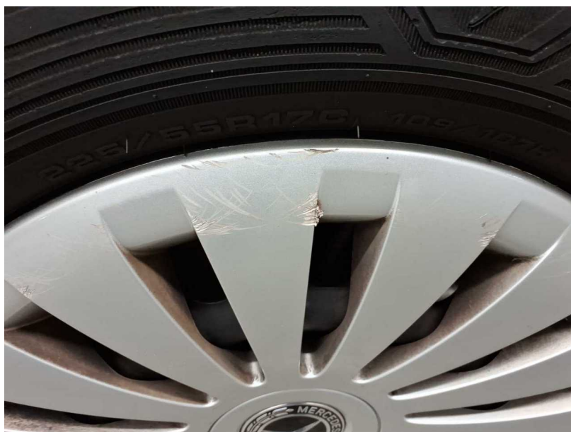
Beschädigung #1: Rad/Reifen: Radblende vorn rechts - verkratzt / verschürft - erneuern
