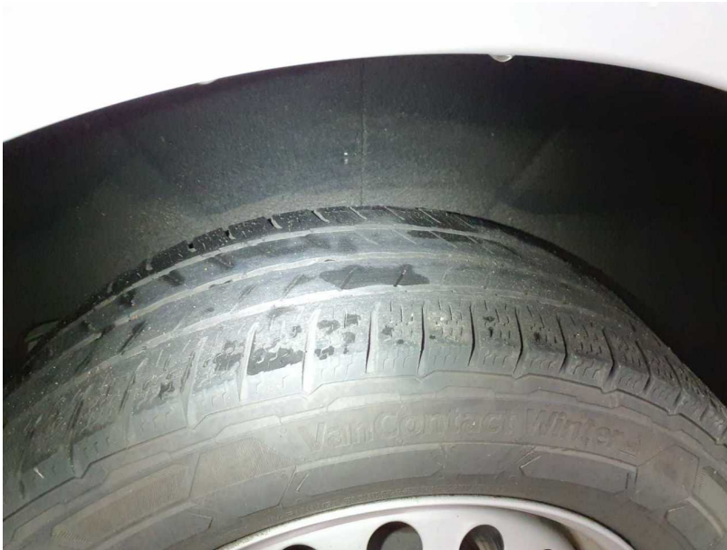
Beschädigung #7: Rad/Reifen: Reifen hinten - verschlissen - erneuern
