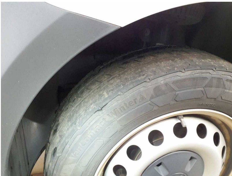
Beschädigung #8: Rad/Reifen: Reifen vorn - verschlissen - erneuern
