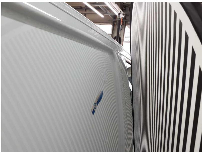
Beschädigung #10: Schiebetür rechts: Schiebetür - verformt - instandsetzen und lackieren
