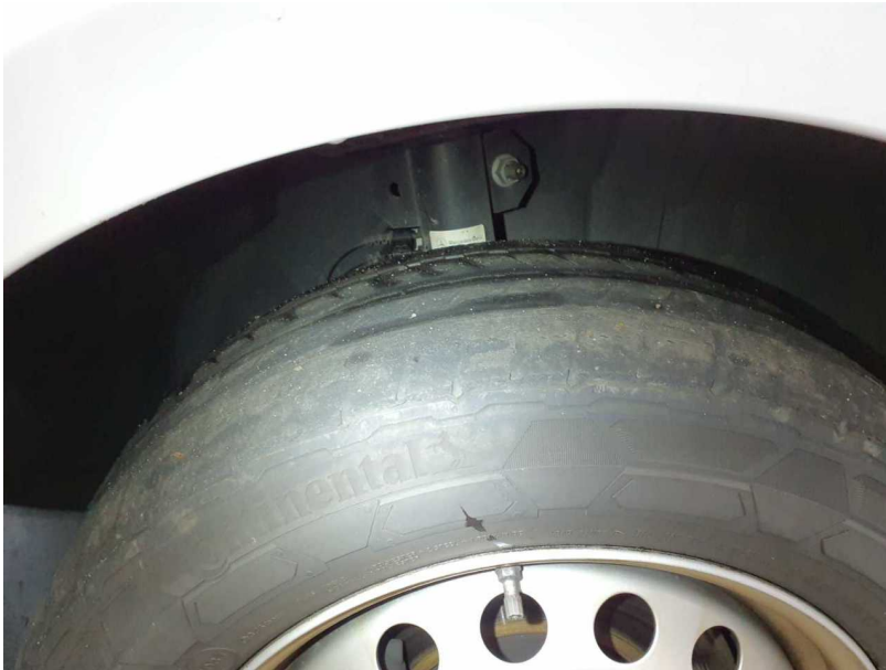
Beschädigung #8: Rad/Reifen: Reifen vorn - verschlissen - erneuern
