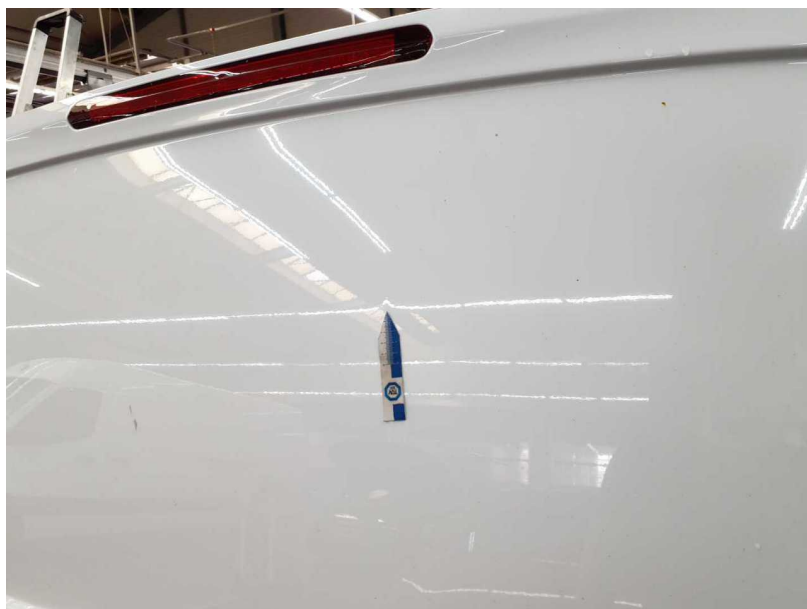
Beschädigung #1: Heckklappe/-tür: Heckklappe (Beulen) - beschädigt - Smart Repair
