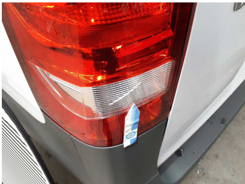
Beschädigung #5: Heckleuchte: Heckleuchte links - gebrochen / gerissen - erneuern
