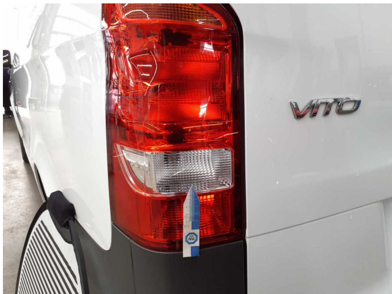
Beschädigung #5: Heckleuchte: Heckleuchte links - gebrochen / gerissen - erneuern
