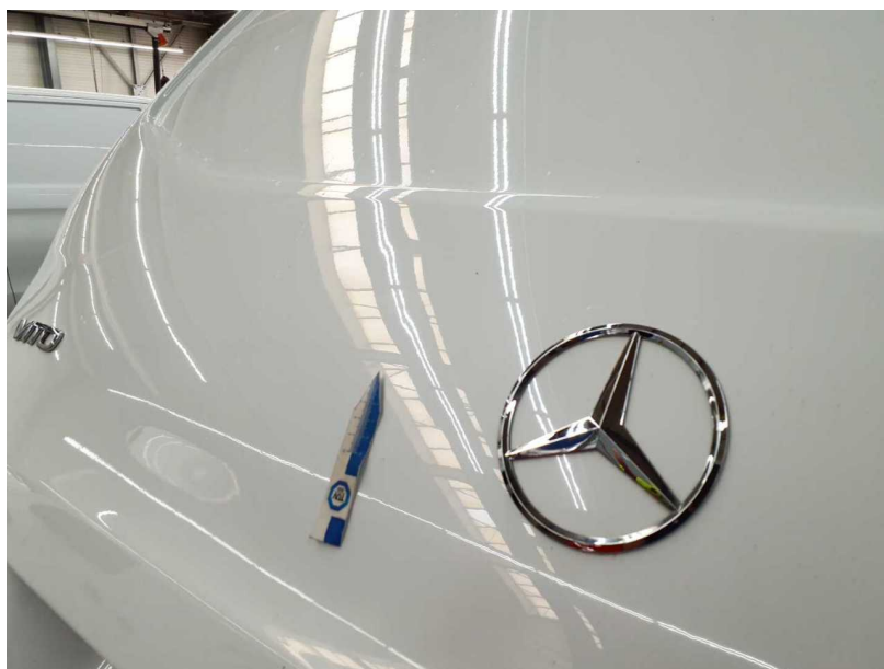
Beschädigung #1: Heckklappe/-tür: Heckklappe (Beulen) - beschädigt - Smart Repair
