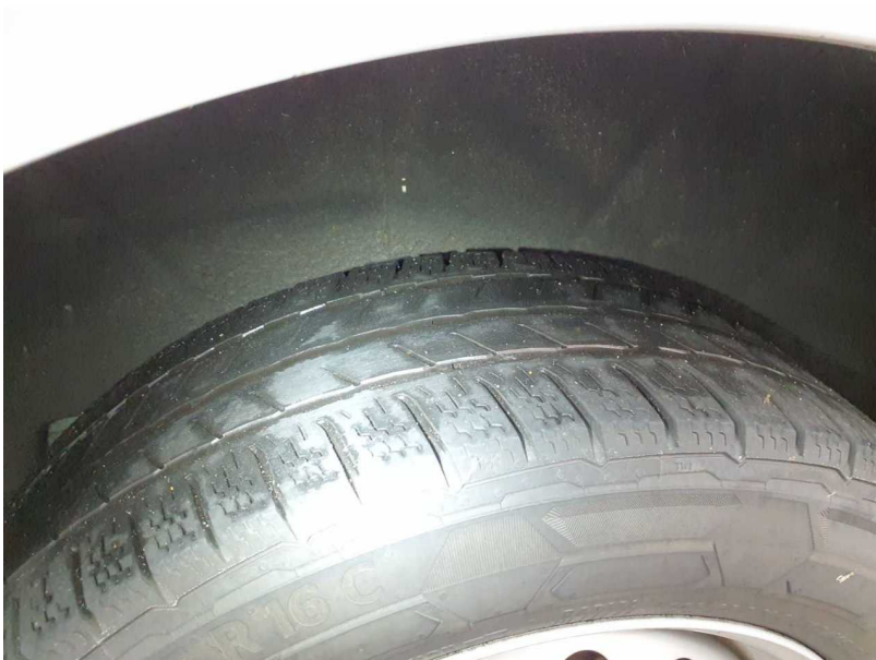
Beschädigung #7: Rad/Reifen: Reifen hinten - verschlissen - erneuern
