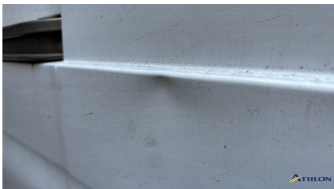
15. porta posteriore - destra 1 ammaccatura
