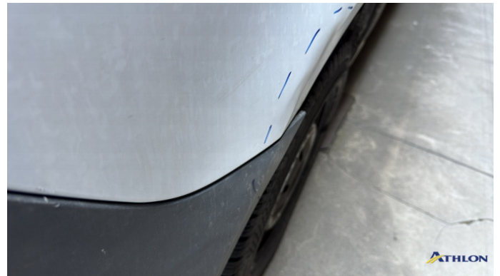
3. parafango anteriore - sinistro 2 ammaccature
