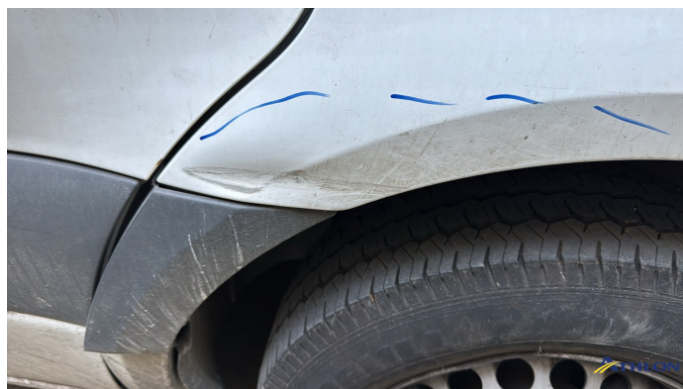
18. Parafango anteriore - destro 2 ammaccature
