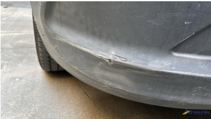
2. paraurti posteriore 3 ammaccature
