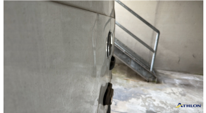
10. portello posteriore 2 ammaccature
