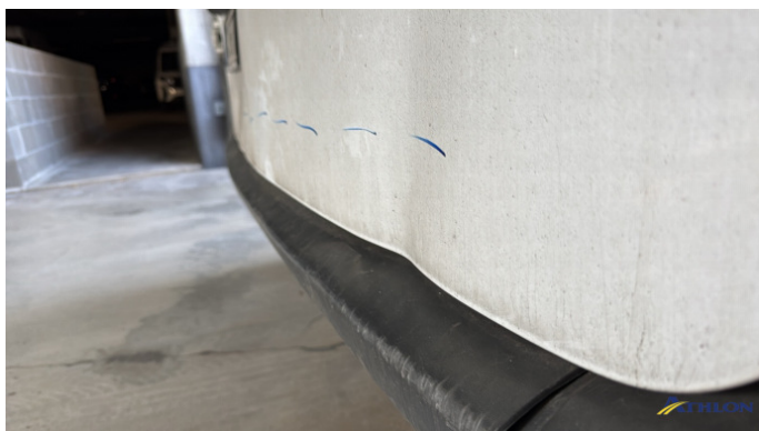
10. portello posteriore 2 ammaccature
