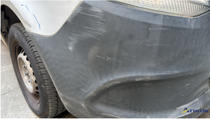
2. paraurti posteriore 3 ammaccature
