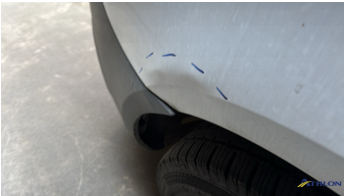
3. parafango anteriore - sinistro 2 ammaccature
