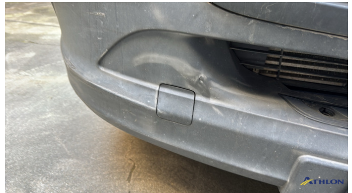
2. paraurti posteriore 3 ammaccature
