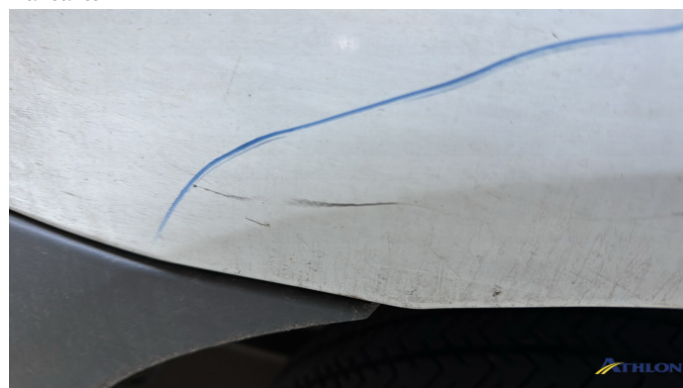
6. parete laterale - posteriore - sinistra 2 ammaccature
