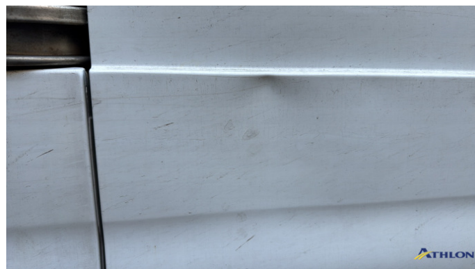
15. porta posteriore - destra 1 ammaccatura
