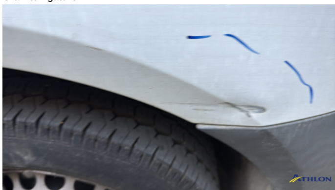
18. Parafango anteriore - destro 2 ammaccature
