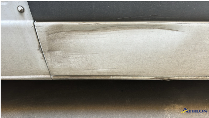
13. porta posteriore - destra 3 ammaccature
