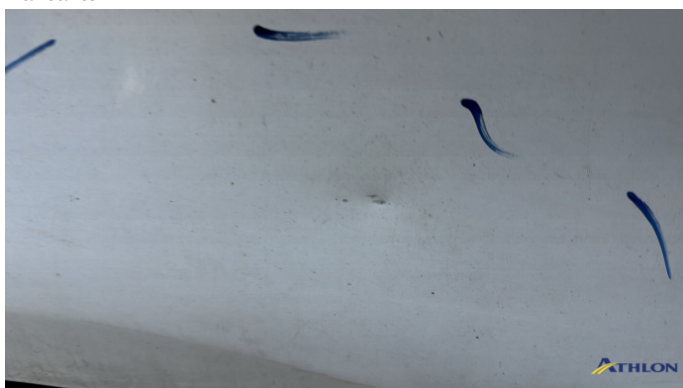
6. parete laterale - posteriore - sinistra 2 ammaccature
