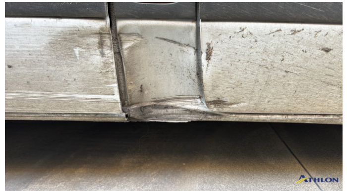
14. sottoporta - destra 3 ammaccature
