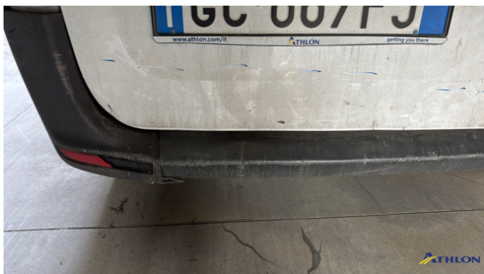
9. paraurti posteriore 3 ammaccature
