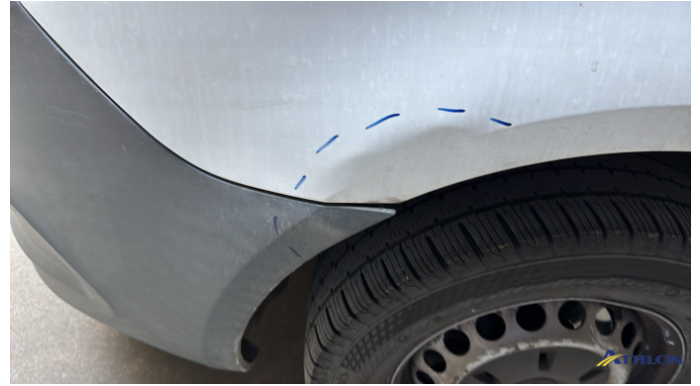
3. parafango anteriore - sinistro 2 ammaccature
