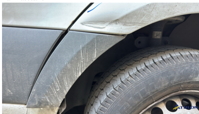
18. Parafango anteriore - destro 2 ammaccature
