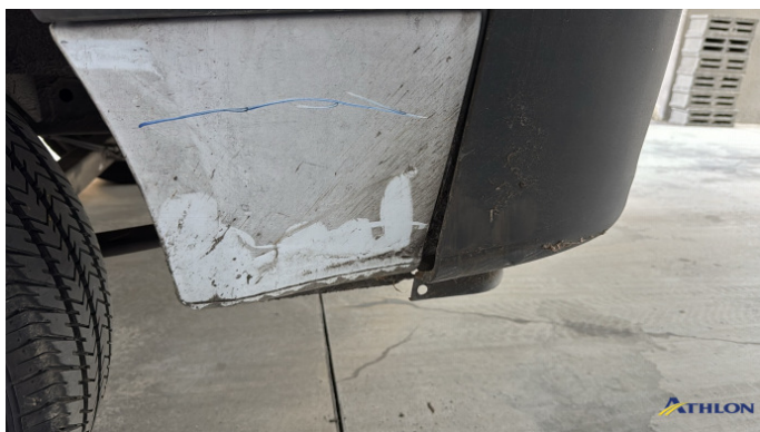
6. parete laterale - posteriore - sinistra 2 ammaccature
