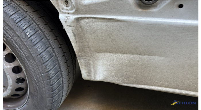
13. porta posteriore - destra 3 ammaccature
