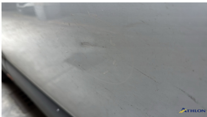
6. parete laterale - posteriore - sinistra 2 ammaccature
