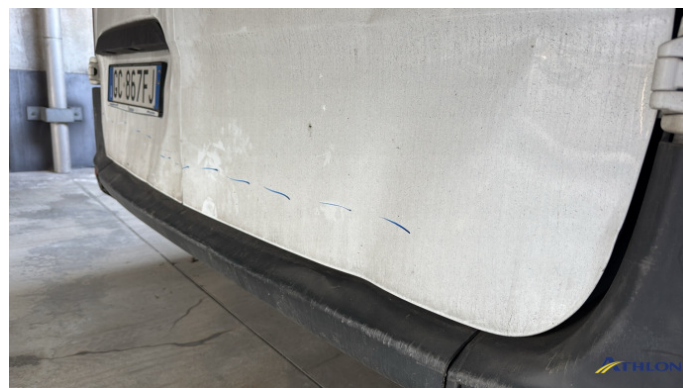
10. portello posteriore 2 ammaccature
