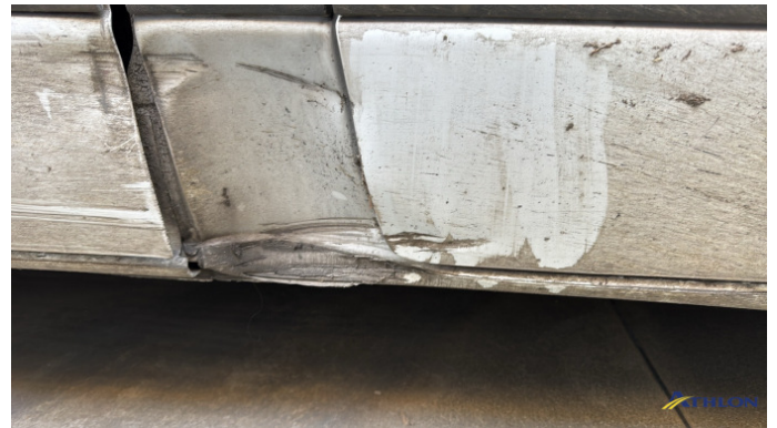
14. sottoporta - destra 3 ammaccature
