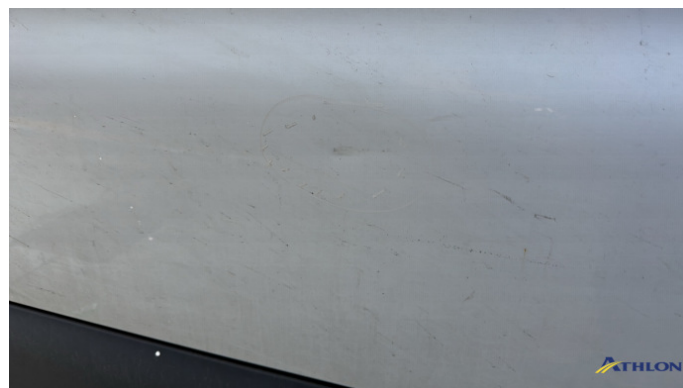
6. parete laterale - posteriore - sinistra 2 ammaccature
