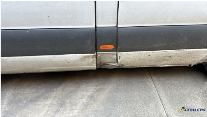
14. sottoporta - destra 3 ammaccature
