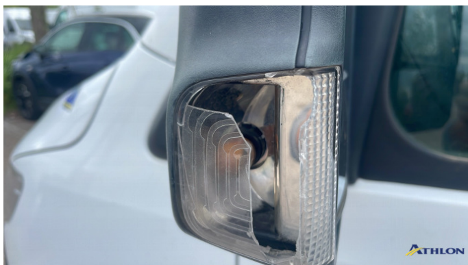
2. retrovisore esterno scatola - sinistro Rotto
