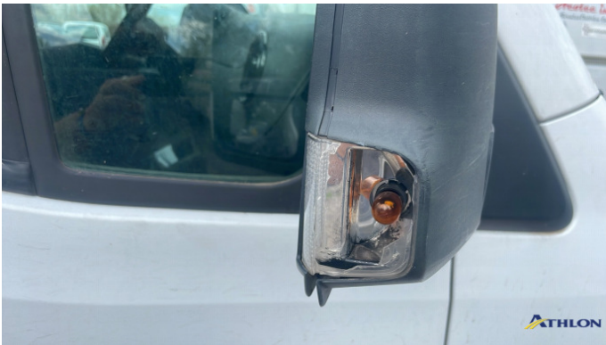
10. retrovisore esterno scatola - destro Rotto
