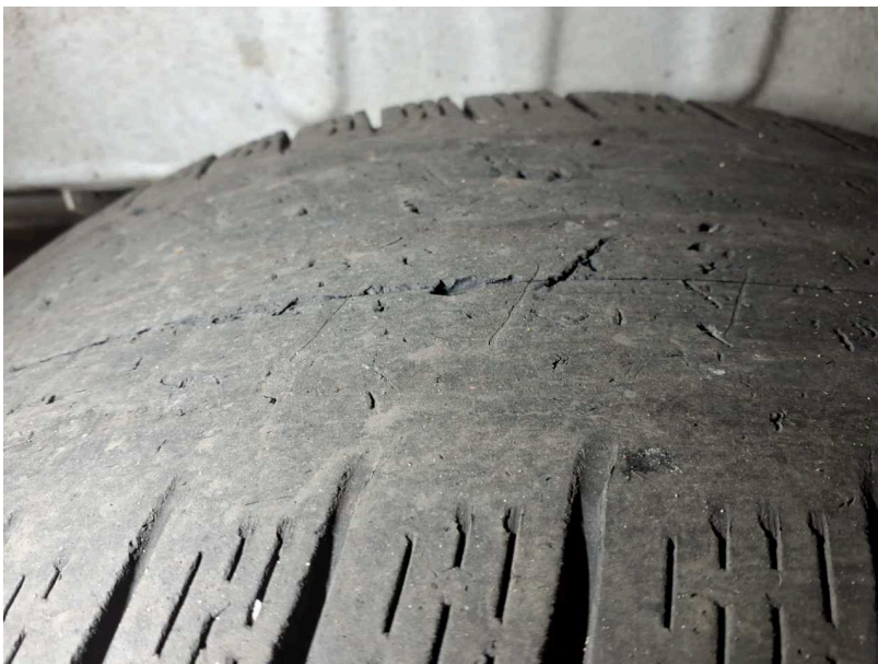
Beschädigung #8: Rad/Reifen: Reifen hinten rechts - verschlissen - erneuern
