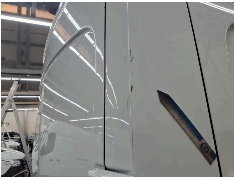
Beschädigung #14: Karosserie: Eckbeplankung rechts - verkratzt / verschürft - lackieren
