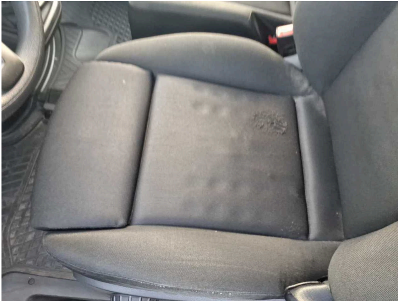
Beschädigung #12: Sitz vorn: Sitzbezug links - verschlissen - erneuern
