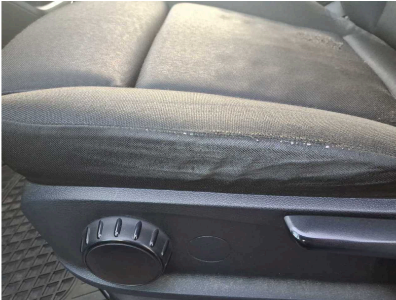
Beschädigung #12: Sitz vorn: Sitzbezug links - verschlissen - erneuern
