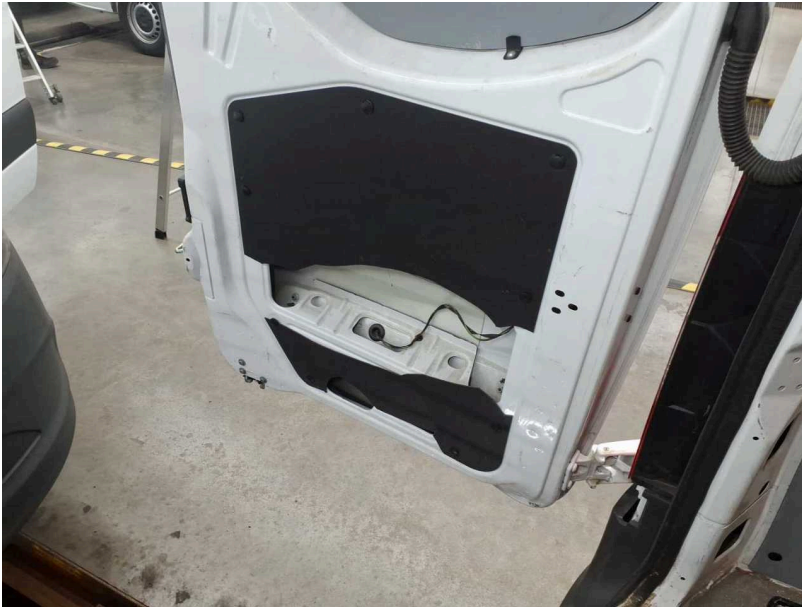
Beschädigung #4: Heckklappe/-tür: Verkl. Hecktür Hartfaser unten - gebrochen / gerissen - erneuern
