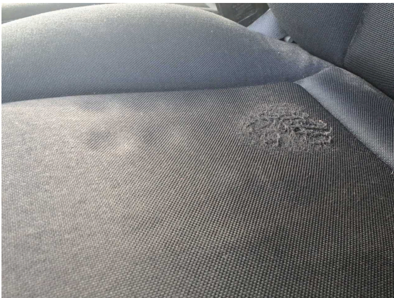
Beschädigung #12: Sitz vorn: Sitzbezug links - verschlissen - erneuern
