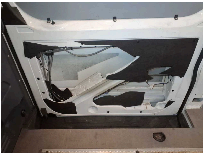
Beschädigung #10: Verkleidungen/Abdeckungen: Schiebetürverkleidung re Holzdekor - gebrochen / gerissen - erneuern
