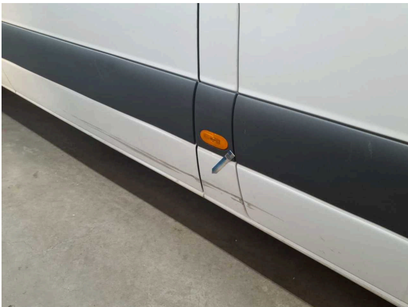
Beschädigung #16: Karosserie: B-Säule rechts - verformt - instandsetzen und lackieren
