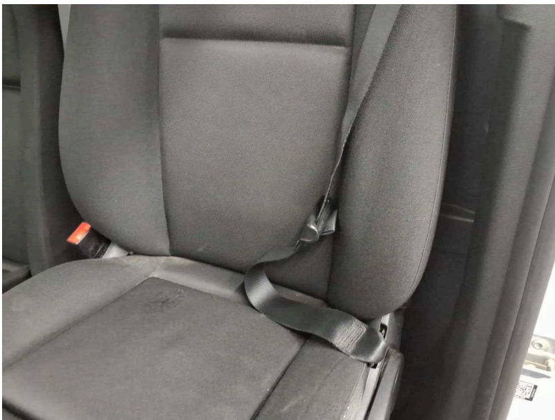
Beschädigung #13: Gurtsystem vorn: Sicherheitsgurt vorn links - verschlissen - erneuern
