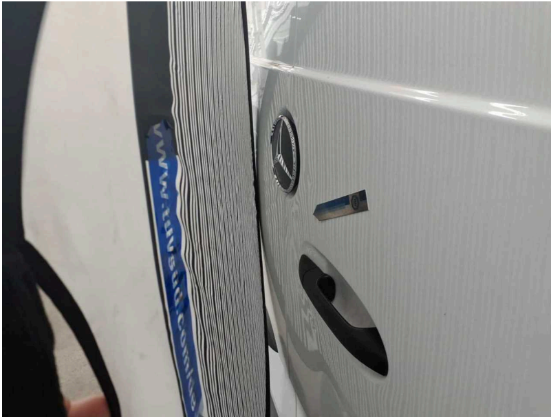
Beschädigung #26: Heckklappe/-tür: Hecktür rechts - verformt - instandsetzen und lackieren
