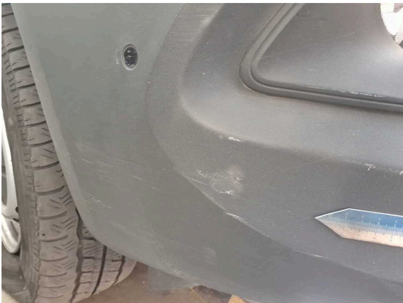
Beschädigung #22: Stossfänger vorn: Stossfänger mit Parktronic - verkratzt / verschürft - erneuern
