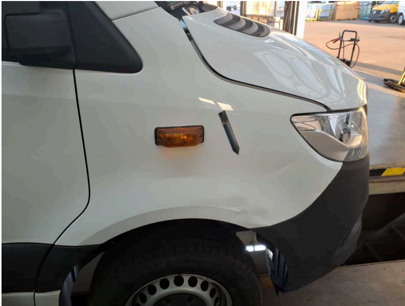
Beschädigung #20: Kotflügel rechts: Kotflügel rechts - verformt - instandsetzen und lackieren
