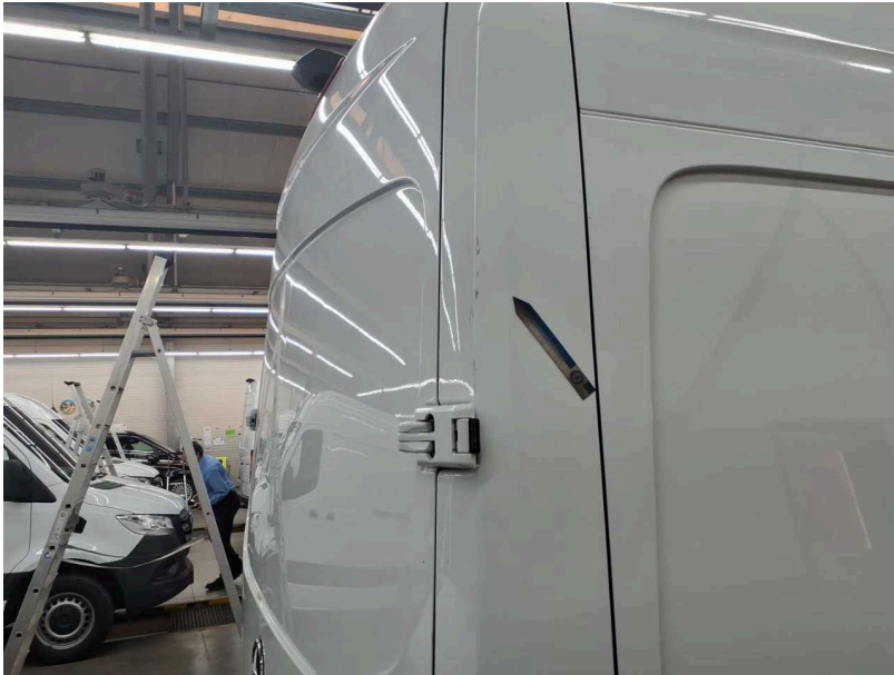
Beschädigung #14: Karosserie: Eckbeplankung rechts - verkratzt / verschürft - lackieren
