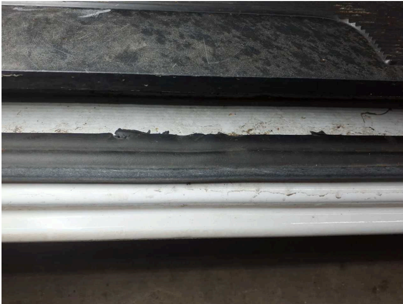
Beschädigung #7: Schiebetür rechts: Türdichtung - gebrochen / gerissen - erneuern
