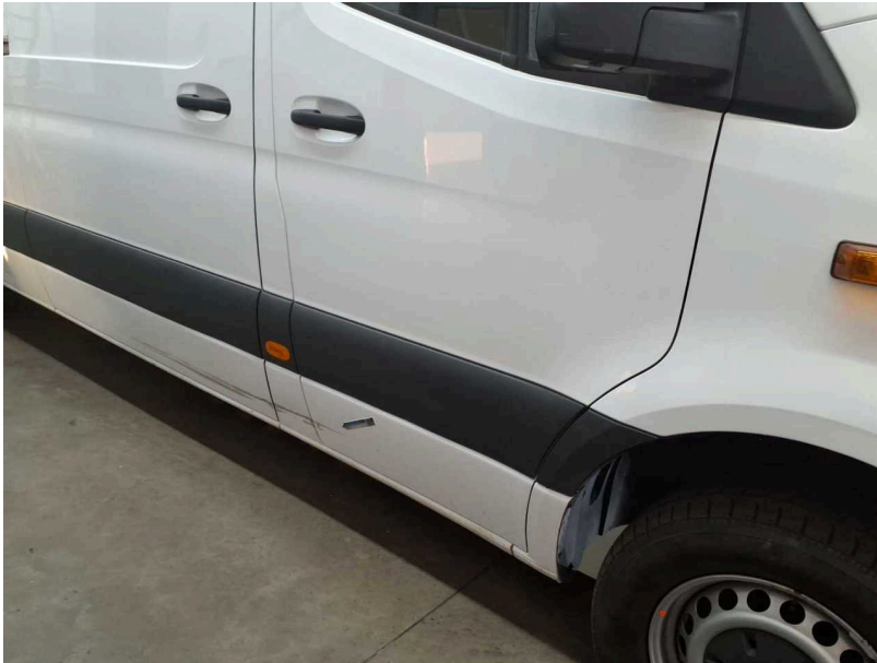
Beschädigung #23: Tür vorn rechts: Tür - verformt - instandsetzen und lackieren
