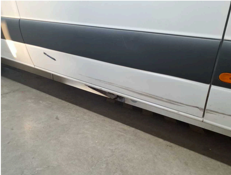
Beschädigung #25: Schiebetür rechts: Schiebetür - verformt - instandsetzen und lackieren
