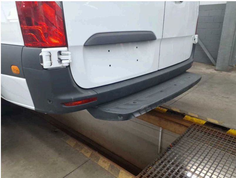
Beschädigung #15: Stossfänger hinten: Verkl. Stossfänger Auftritt mit Parktronic (Inkl.ecke li.) - verkratzt / verschürft - erneuern
