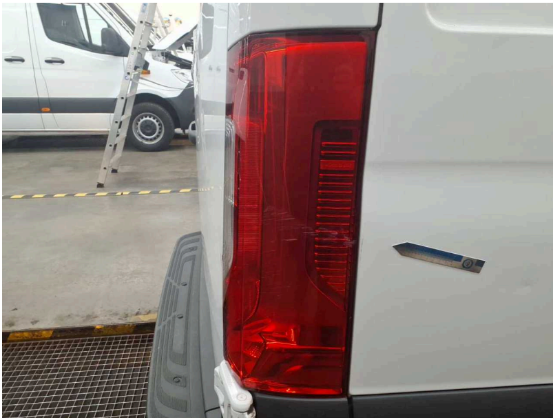
Beschädigung #11: Heckleuchte: Heckleuchte rechts - verkratzt / verschürft - erneuern
