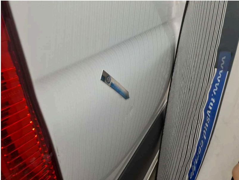
Beschädigung #24: Seitenwand rechts: Seitenwand - Delle(n) - instandsetzen und lackieren
