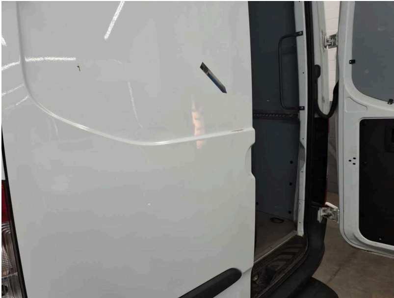
Beschädigung #29: Heckklappe/-tür: Hecktür links - gebrochen / gerissen - erneuern
