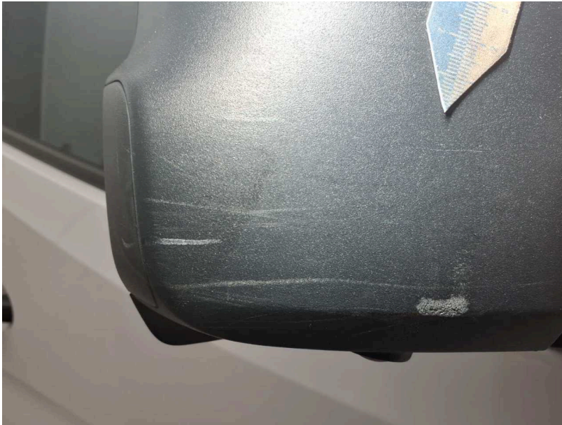
Beschädigung #3: Außenspiegel rechts: Abdeckkappe (Inkl.spiegel) - gebrochen / gerissen - erneuern
