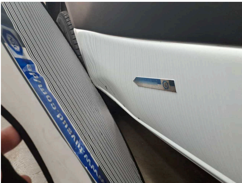
Beschädigung #21: Seitenwand links: Seitenwand hinten unterhalb - verformt - instandsetzen und lackieren
