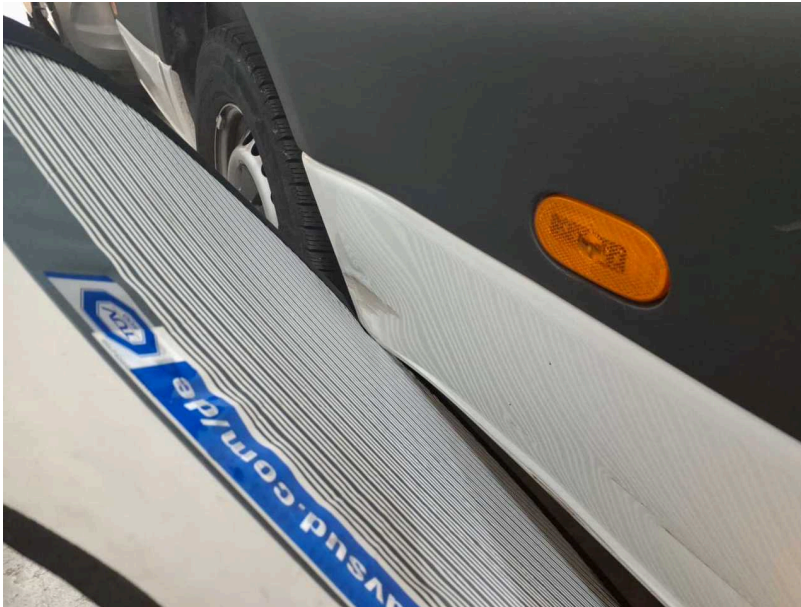
Beschädigung #19: Seitenwand rechts: Seitenwand hinten unterhalb - verformt - instandsetzen und lackieren
