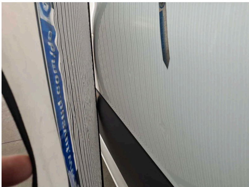
Beschädigung #5: Seitenwand links: Seitenwand Mitte - Delle(n) - Smart Repair
