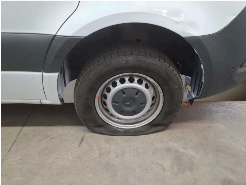
Beschädigung #9: Rad/Reifen: Reifen vorn rechts (Kostenausweitung mgl) - gebrochen / gerissen - erneuern
