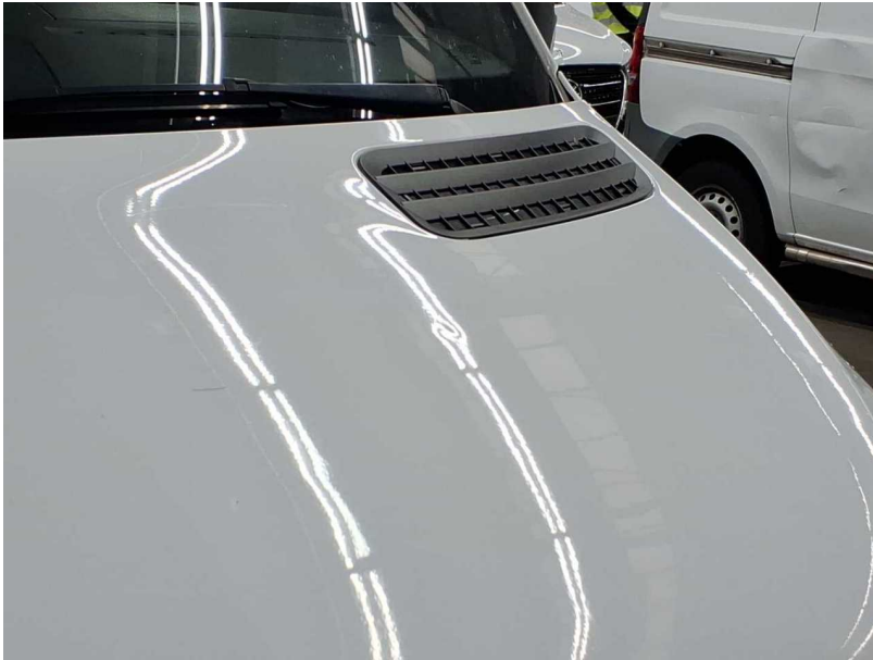
Beschädigung #17: Motorhaube: Motorhaube - Delle(n) - instandsetzen und lackieren
