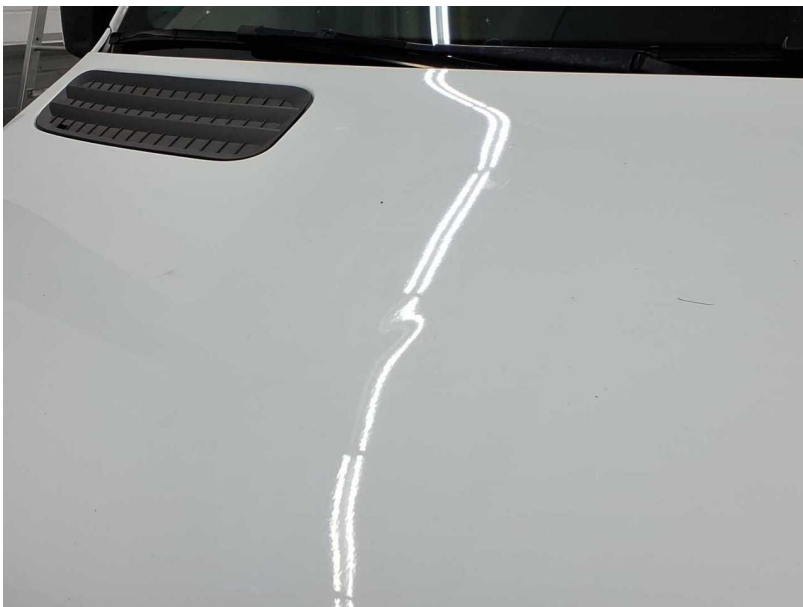
Beschädigung #17: Motorhaube: Motorhaube - Delle(n) - instandsetzen und lackieren
