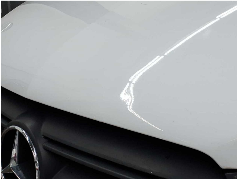
Beschädigung #17: Motorhaube: Motorhaube - Delle(n) - instandsetzen und lackieren
