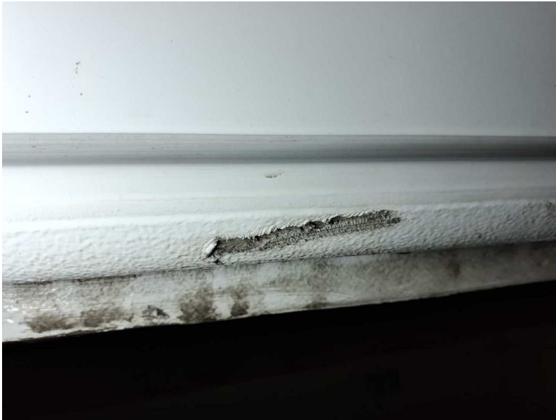
Beschädigung #19: Schweller rechts: Schweller (+ Beplankung Kotflügel VRU ersetzen) - verformt - instandsetzen und lackieren
