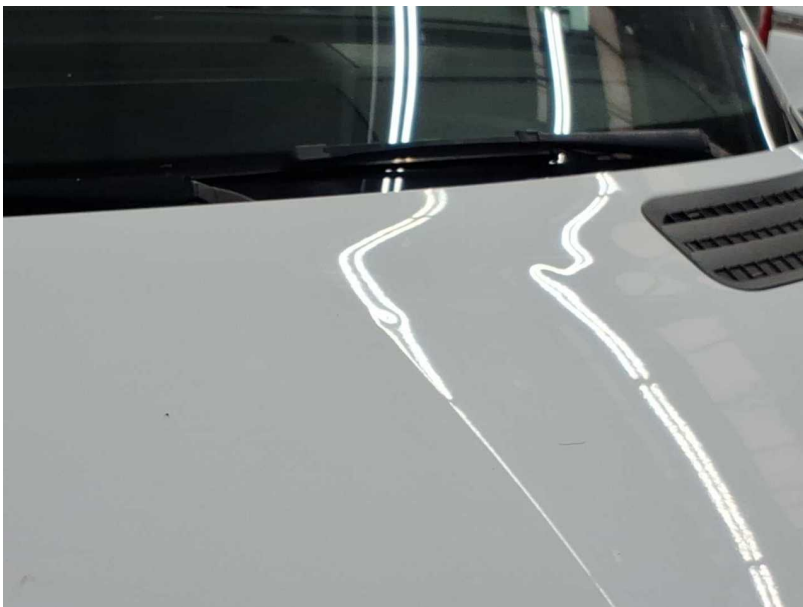
Beschädigung #17: Motorhaube: Motorhaube - Delle(n) - instandsetzen und lackieren
