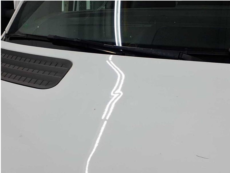
Beschädigung #17: Motorhaube: Motorhaube - Delle(n) - instandsetzen und lackieren
