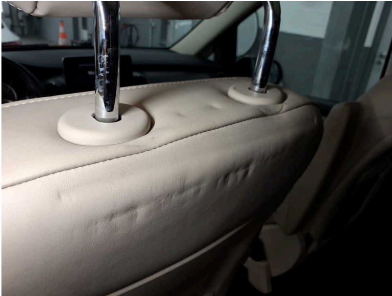
Beschädigung #21: Sitz vorn: Lehnenbezug links - verformt - erneuern
