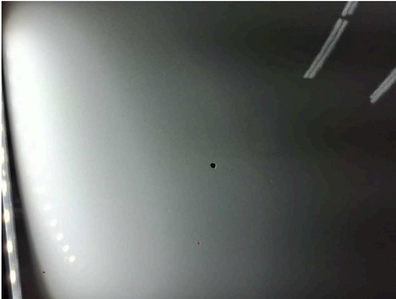
Beschädigung #9: Motorhaube: Motorhaube - Steinschlag - lackieren
