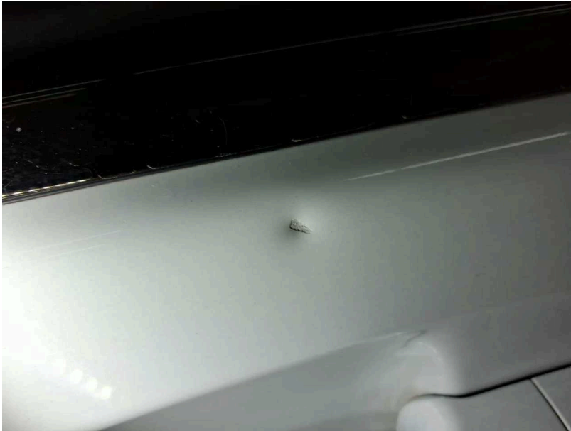
Beschädigung #14: Tür vorn links: Tür - Delle(n) - instandsetzen und lackieren
