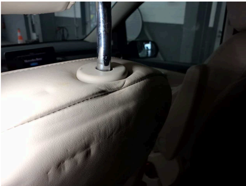
Beschädigung #21: Sitz vorn: Lehnenbezug links - verformt - erneuern
