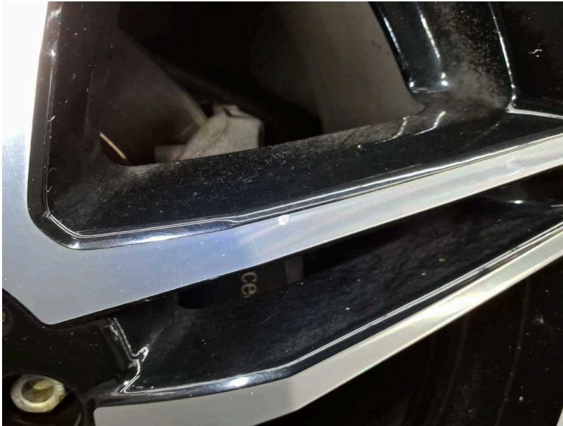
Beschädigung #18: Rad/Reifen: Leichtmetallfelge hinten links - Kratzer - erneuern
