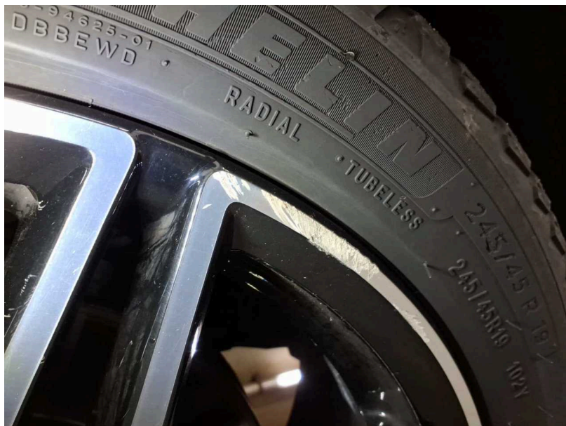
Beschädigung #19: Rad/Reifen: Leichtmetallfelge vorn rechts - Kratzer - erneuern
