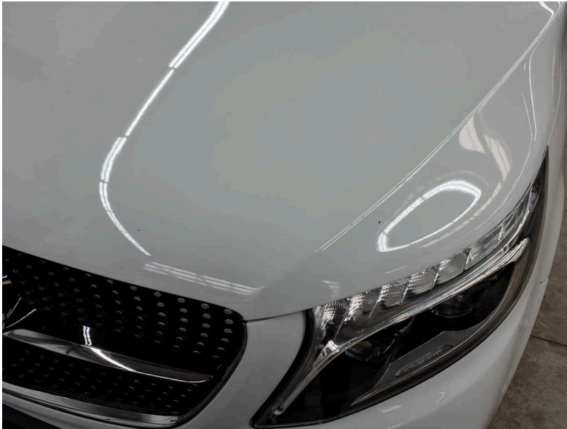
Beschädigung #9: Motorhaube: Motorhaube - Steinschlag - lackieren
