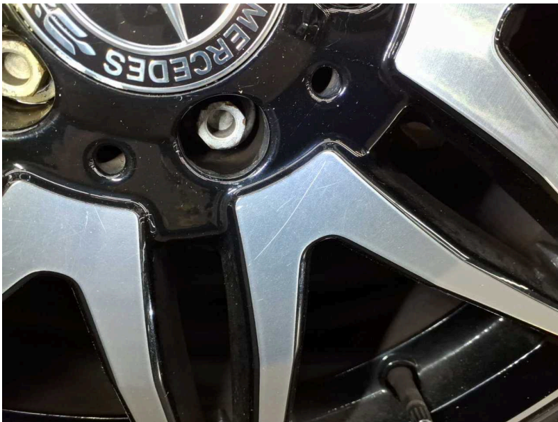
Beschädigung #18: Rad/Reifen: Leichtmetallfelge hinten links - Kratzer - erneuern
