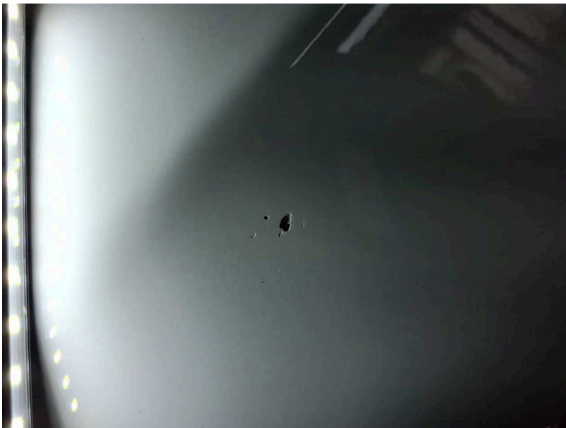
Beschädigung #9: Motorhaube: Motorhaube - Steinschlag - lackieren
