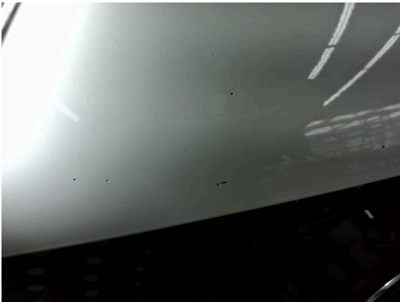
Beschädigung #9: Motorhaube: Motorhaube - Steinschlag - lackieren
