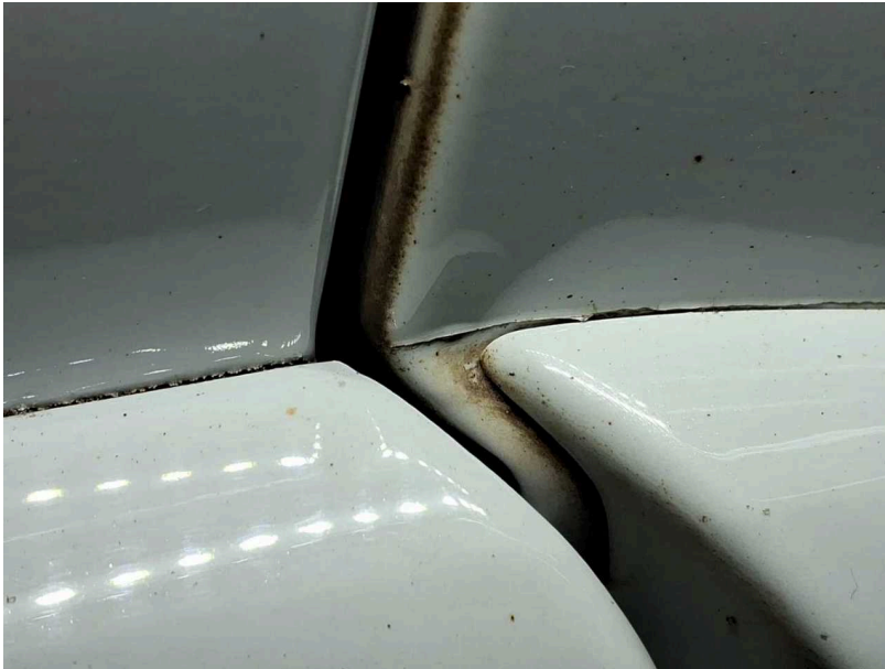
Beschädigung #13: Seitenwand links: Seitenwand - nicht fachgerecht instandgesetzt - lackieren
