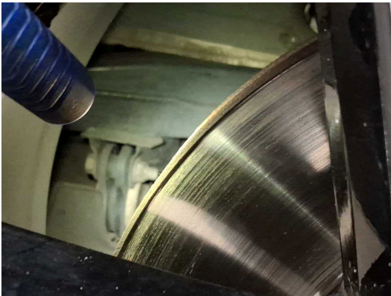
Beschädigung #8: Bremsanlage: Bremsscheiben und Beläge vorn - verschlissen - erneuern
