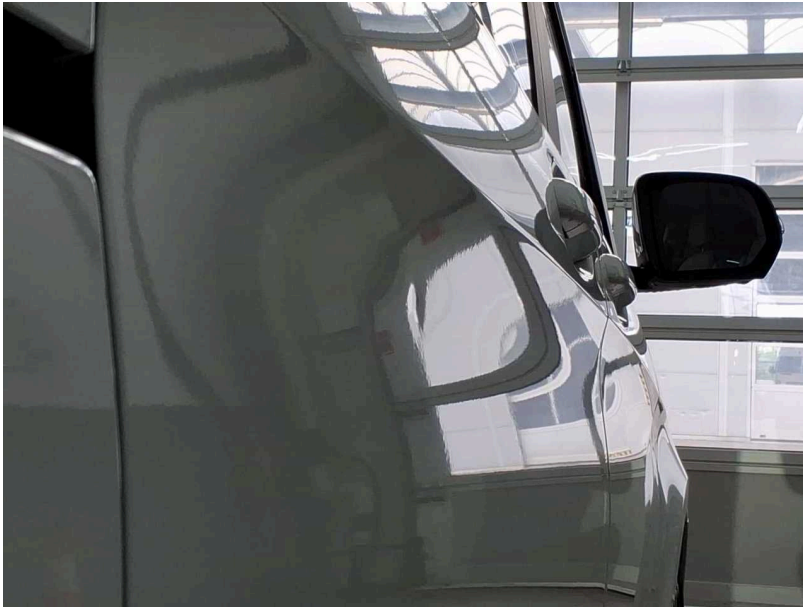
Beschädigung #4: Schiebetür rechts: Schiebetür - Delle(n) - Smart Repair
