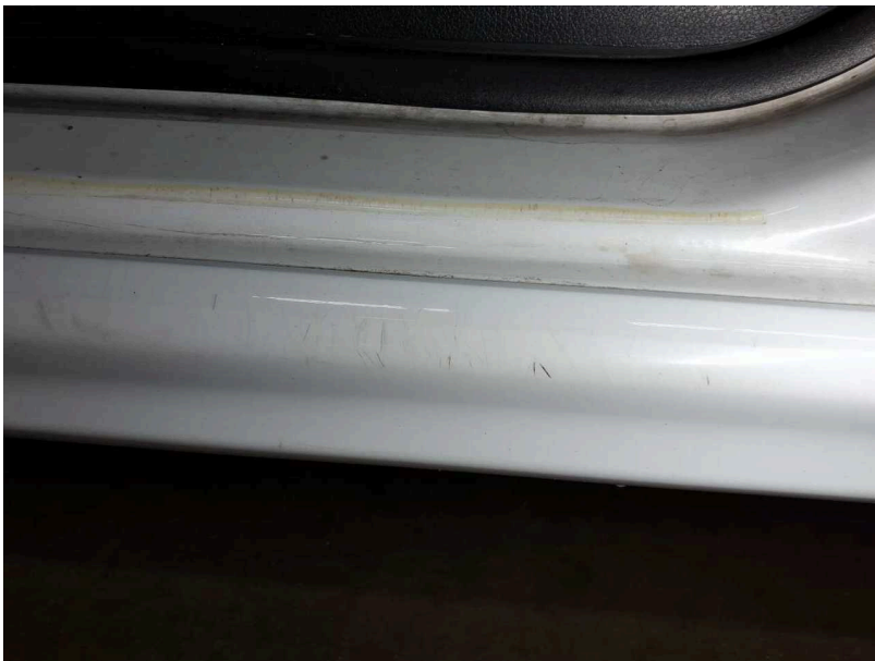
Beschädigung #6: Schweller links: Einstieg (Verkleidung) - Kratzer - lackieren
