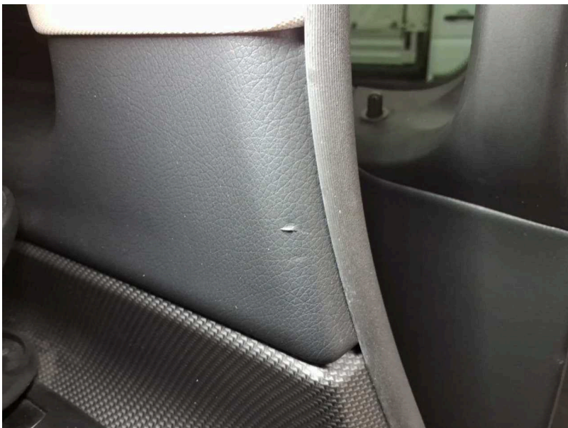
Beschädigung #3: Seitenwand links: Innenverkleidung - gebrochen / gerissen - Smart Repair
