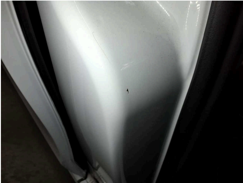
Beschädigung #7: Karosserie: B-Säule rechts - Kratzer - lackieren
