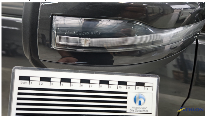
17. Außenspiegel Gehäuse - Rechts Kratzer
