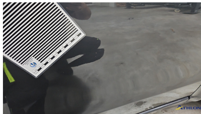
16. Tür Vorne - Rechts Verformt (stark)
