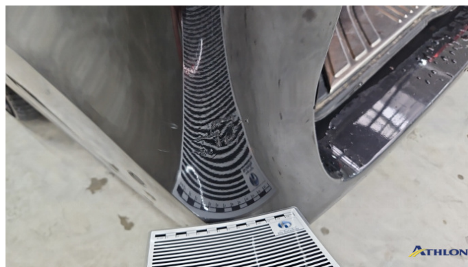
9. Stoßfänger Hinten Verformt (leicht)
