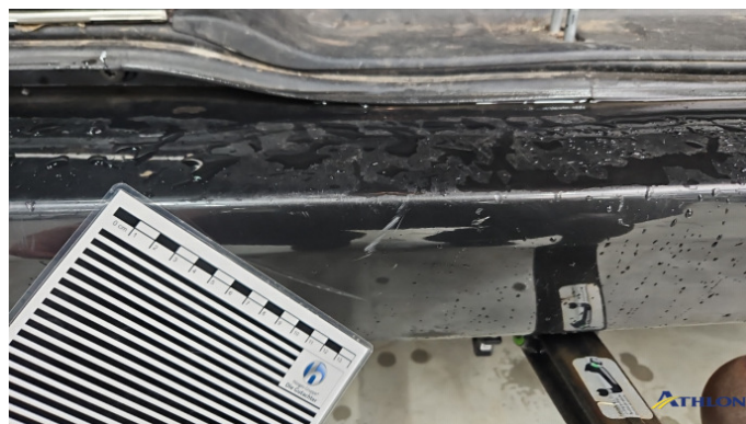
10. Stoßfänger Hinten Kratzer
