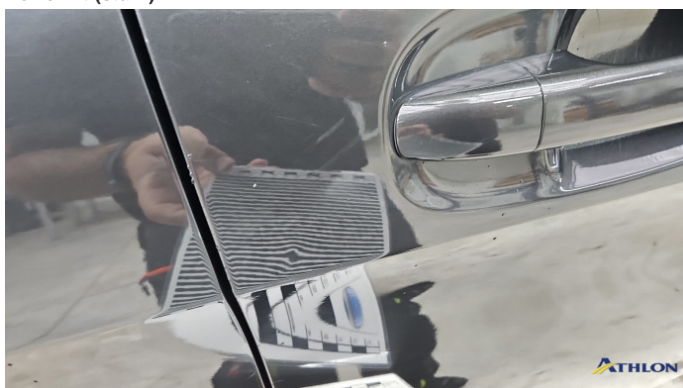
16. Tür Vorne - Rechts Verformt (stark)
