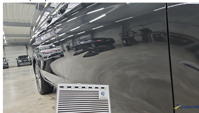
16. Tür Vorne - Rechts Verformt (stark)
