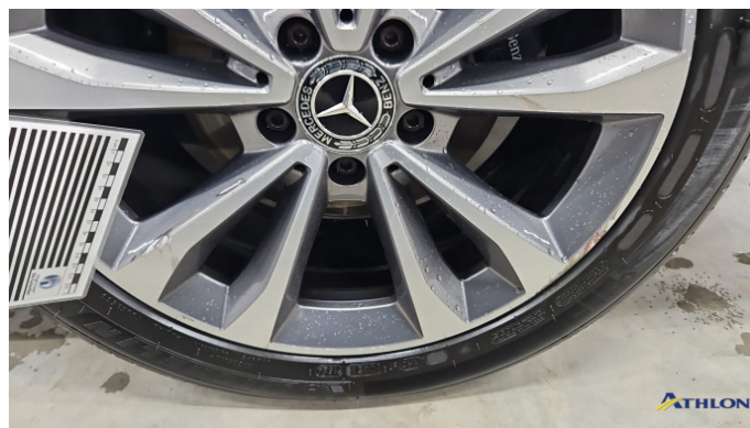
6. Felge Hinten - Links Kratzer
