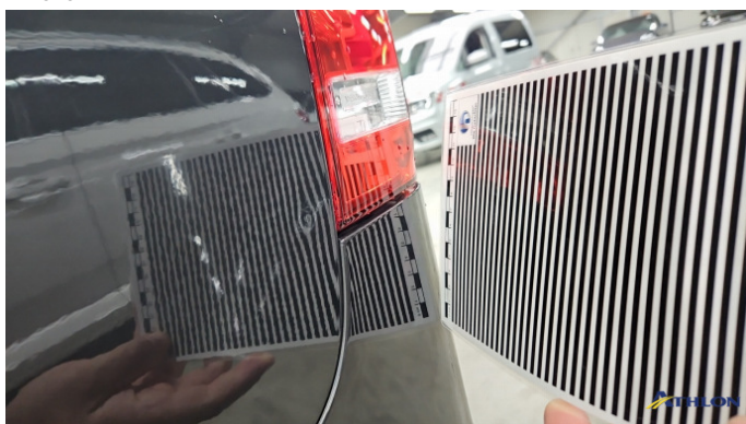
7. Seitenwand - Hinten - Links 1 Delle
