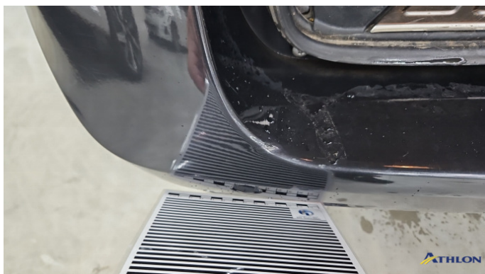
9. Stoßfänger Hinten Verformt (leicht)
