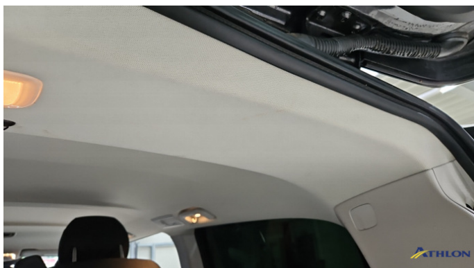
22. Dachhimmel Verschmutzt (leicht)
