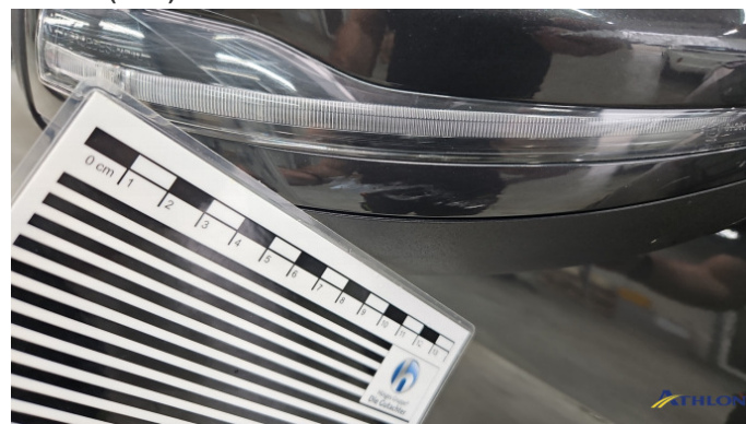
17. Außenspiegel Gehäuse - Rechts Kratzer
