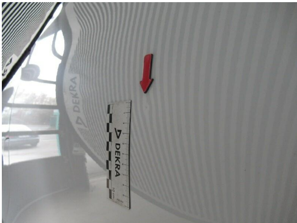
Bild 18 : Seitenteil hinten links, eingedellt, drücken
