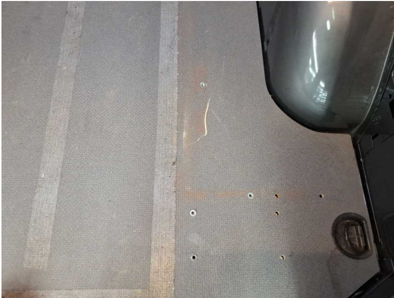
Beschädigung #5: Heckbereich: Holzboden hinten - Löcher - erneuern
