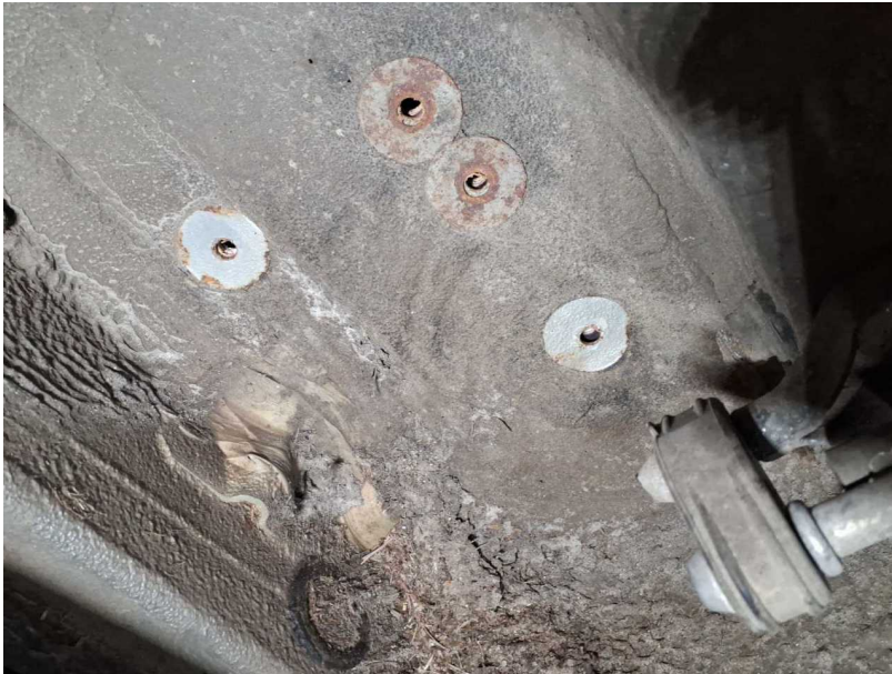
Beschädigung #6: Interieur: Laderaumboden (div. Bohrlöcher i) - beschädigt - instandsetzen und lackieren
