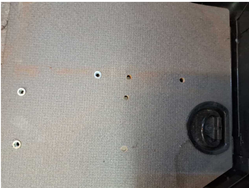
Beschädigung #5: Heckbereich: Holzboden hinten - Löcher - erneuern
