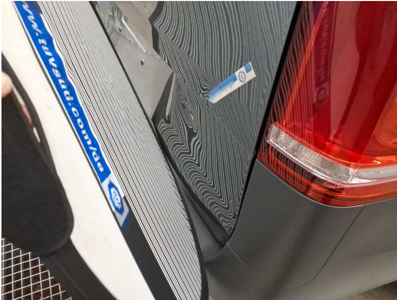
Beschädigung #4: Heckklappe/-tür: Heckklappe - verformt - instandsetzen und lackieren
