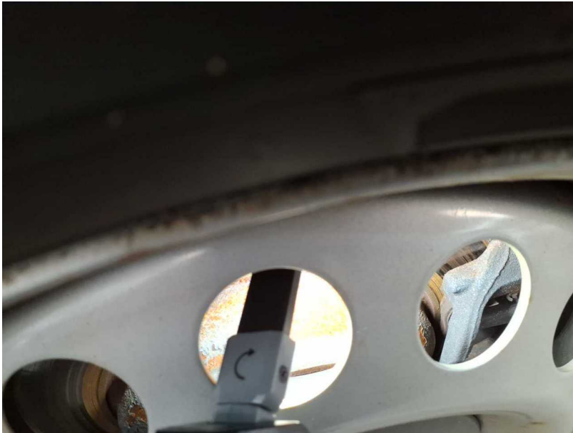
Beschädigung #3: Bremsanlage: Bremsscheiben und Beläge hinten - verschlissen - erneuern
