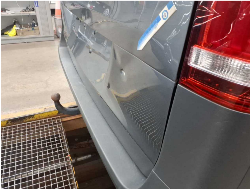
Beschädigung #4: Heckklappe/-tür: Heckklappe - verformt - instandsetzen und lackieren
