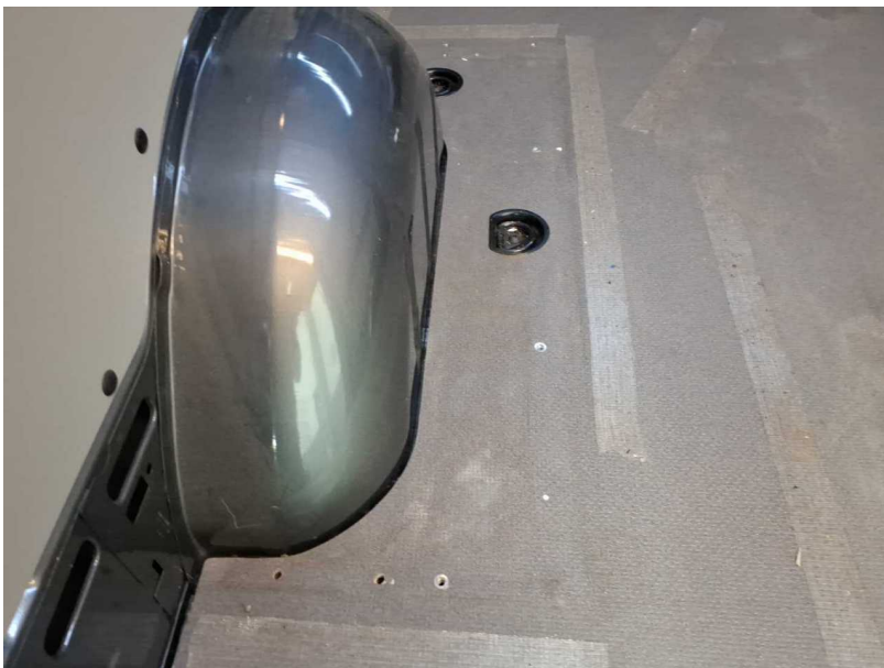
Beschädigung #5: Heckbereich: Holzboden hinten - Löcher - erneuern
