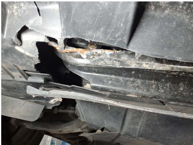
Beschädigung #2: Karosserie: Unterbodenverkleidung (Inkl. Querträger unten - Schadenausweitung möglich) - gebrochen / gerissen - erneuern
