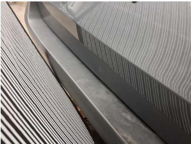
Beschädigung #4: Heckklappe/-tür: Heckklappe - verformt - instandsetzen und lackieren
