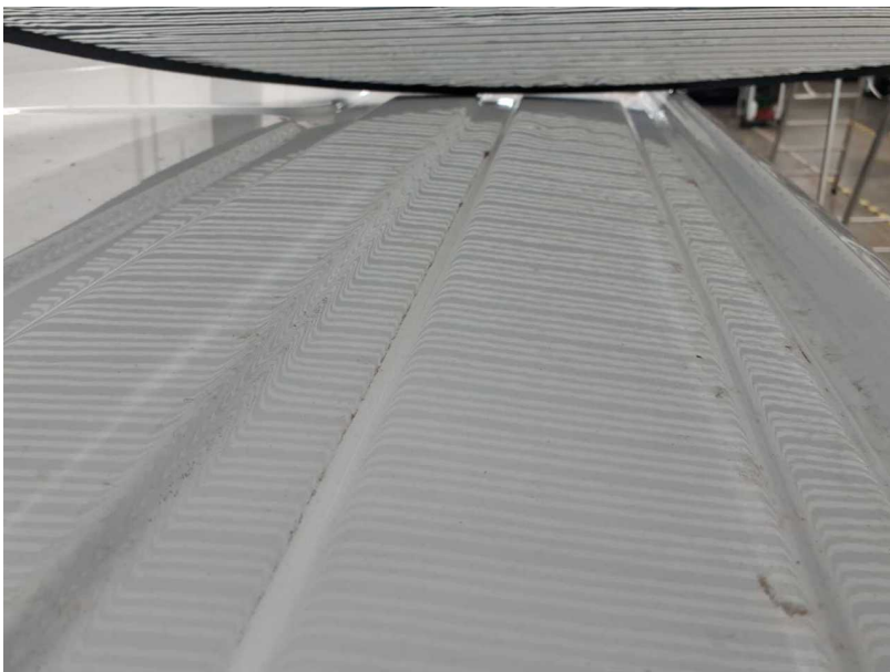
Beschädigung #6: Fahrzeugdach: Dach - Hagelschaden - Smart Repair
