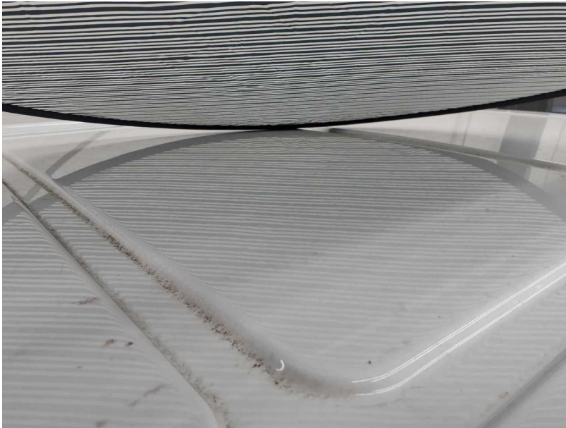
Beschädigung #6: Fahrzeugdach: Dach - Hagelschaden - Smart Repair
