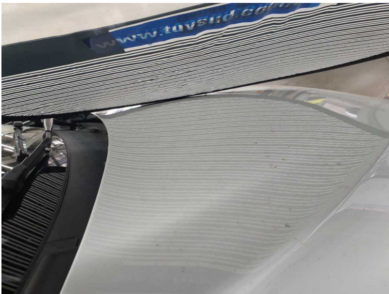
Beschädigung #5: Motorhaube: Motorhaube - Hagelschaden - Smart Repair
