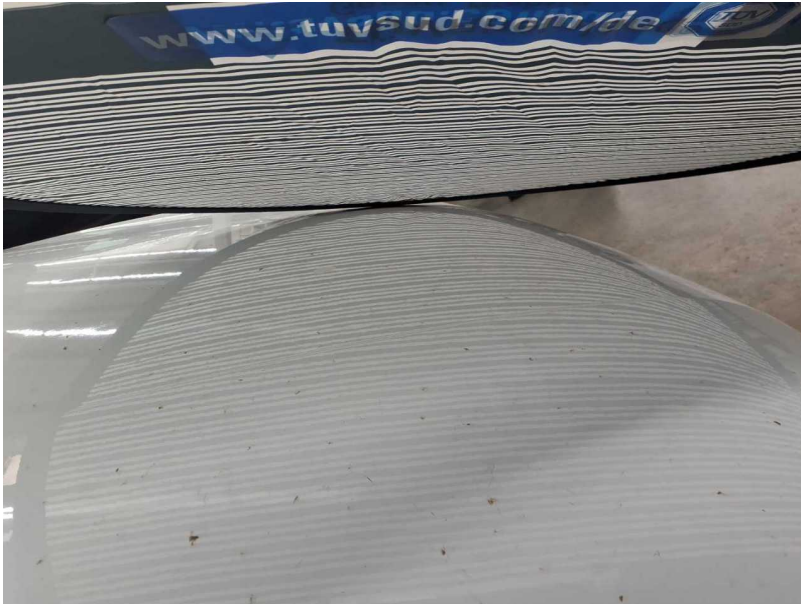
Beschädigung #5: Motorhaube: Motorhaube - Hagelschaden - Smart Repair
