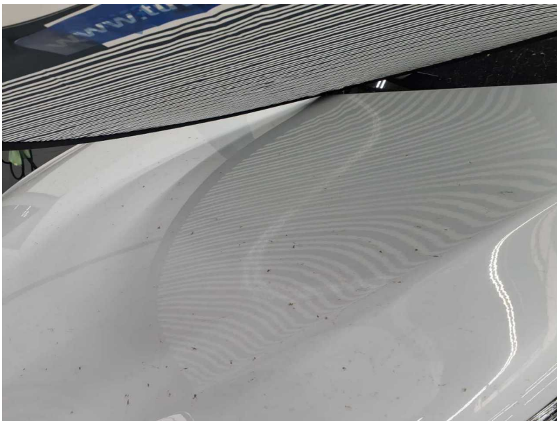
Beschädigung #5: Motorhaube: Motorhaube - Hagelschaden - Smart Repair
