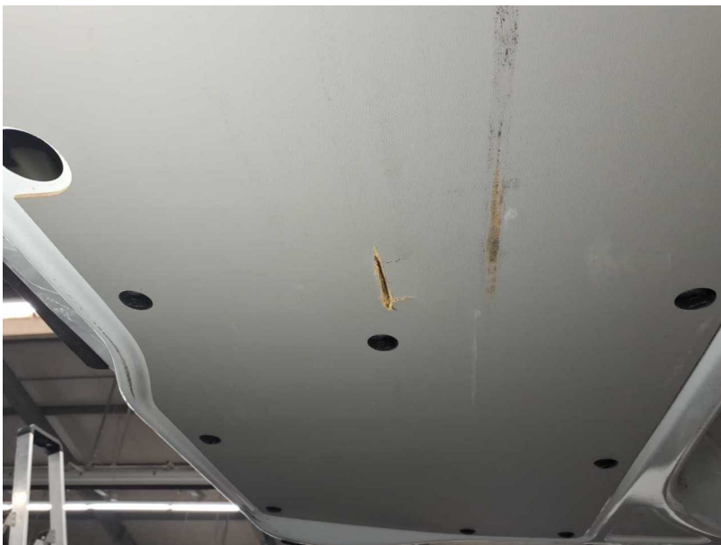
Beschädigung #9: Heckklappe/-tür: Heckklappe (Inkl. Verkleidung) - verformt - instandsetzen und lackieren
