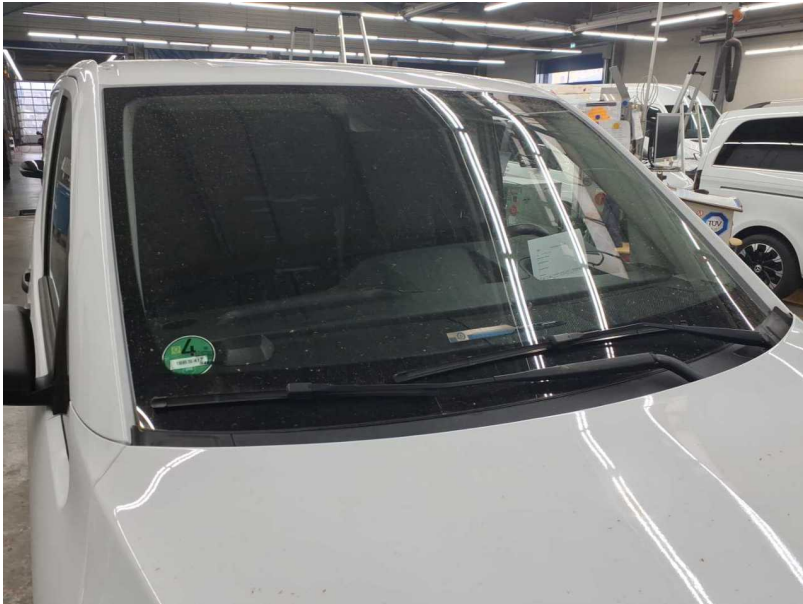
Beschädigung #10: Verglasung: Frontscheibe - verkratzt / verschürft - erneuern
