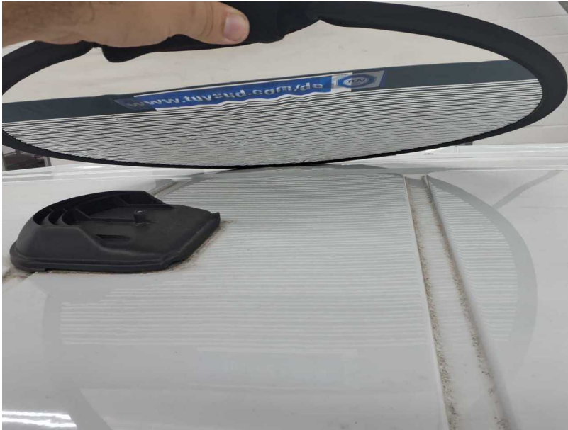
Beschädigung #6: Fahrzeugdach: Dach - Hagelschaden - Smart Repair
