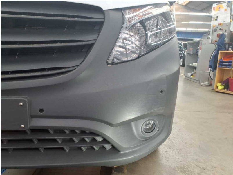
Beschädigung #8: Stossfänger vorn: Stossfänger mit Parktronic - verkratzt / verschürft - erneuern
