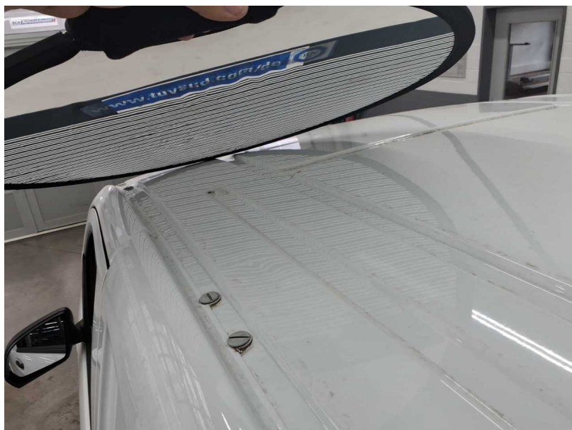
Beschädigung #6: Fahrzeugdach: Dach - Hagelschaden - Smart Repair
