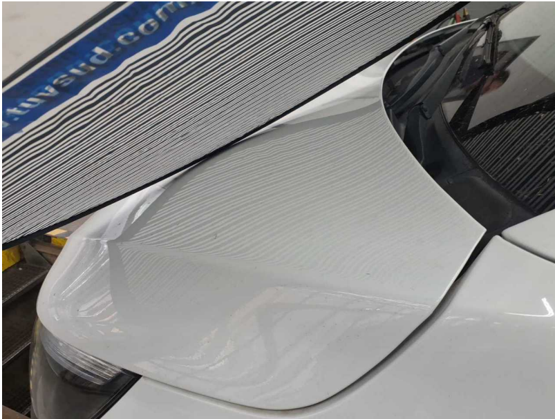
Beschädigung #5: Motorhaube: Motorhaube - Hagelschaden - Smart Repair
