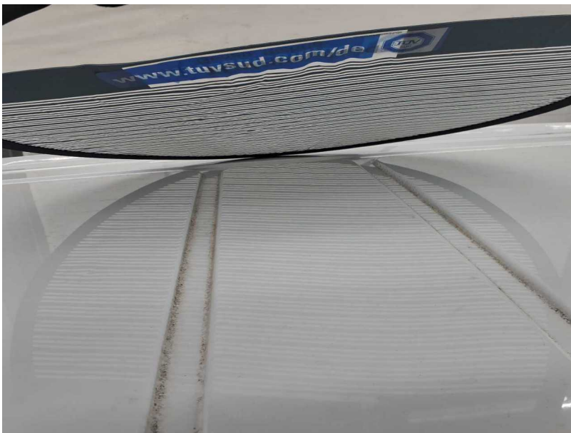
Beschädigung #6: Fahrzeugdach: Dach - Hagelschaden - Smart Repair
