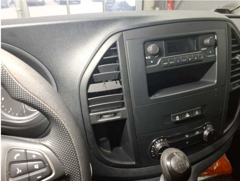
Beschädigung #2: Instrumententafel: Luftdüse Mitte - gebrochen / gerissen - erneuern
