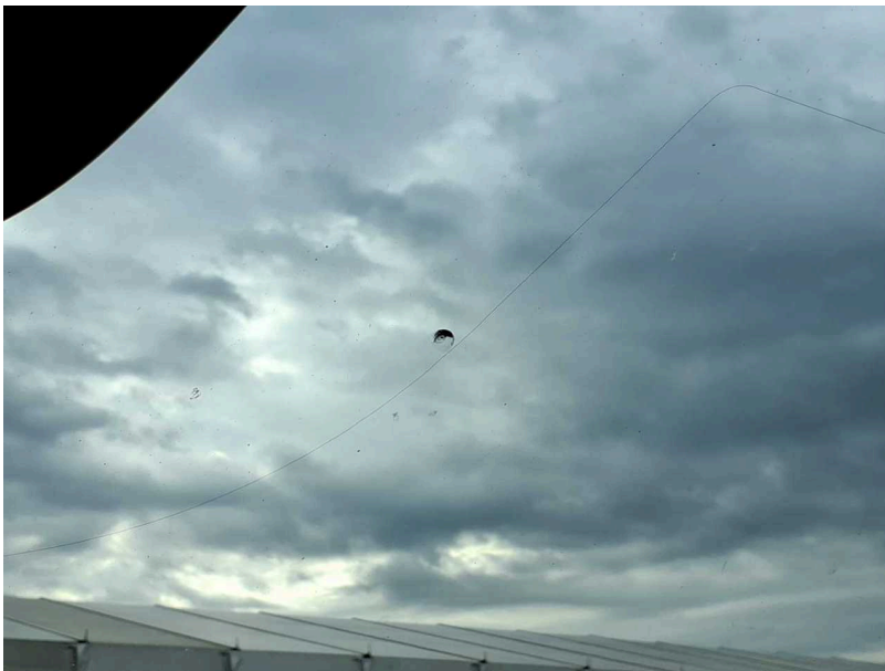
Beschädigung #16: Verglasung: Frontscheibe -
