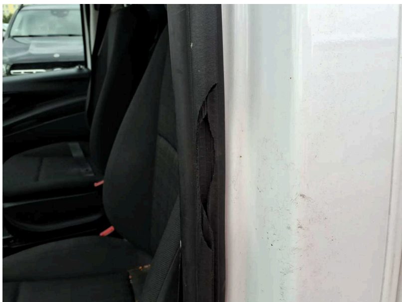
Beschädigung #4: Tür vorn links: Türdichtung -
