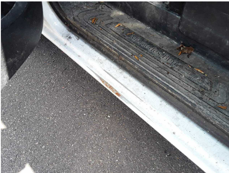
Beschädigung #2: Schweller links: Einstieg - verkratzt / verschürft - lackieren
