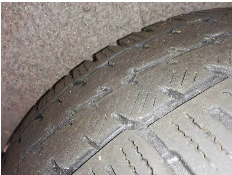
Beschädigung #3: Rad/Reifen: Reifen hinten - verschlissen - erneuern
