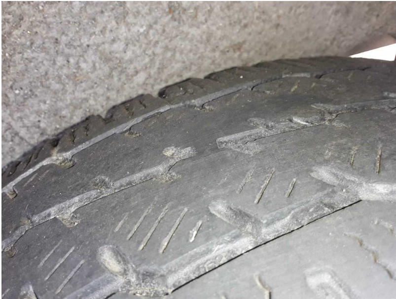
Beschädigung #3: Rad/Reifen: Reifen hinten - verschlissen - erneuern
