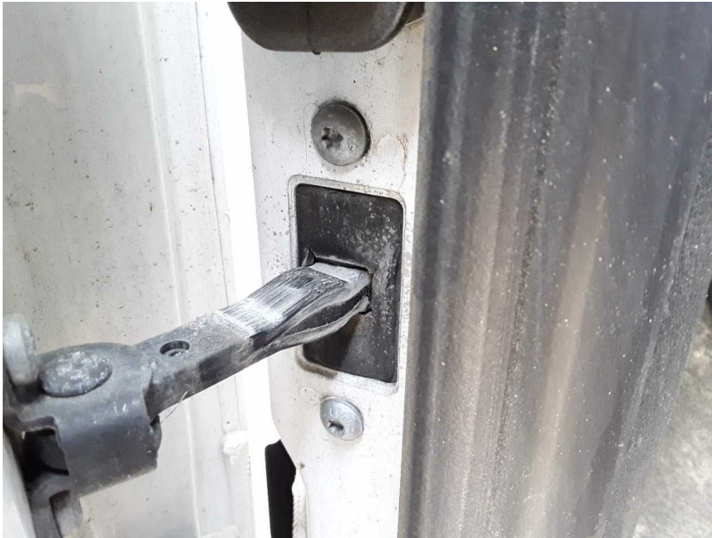
Beschädigung #4: Karosserie: A-Säule links - gebrochen / gerissen - instandsetzen und lackieren
