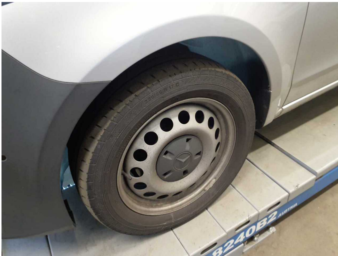
Damage 3: Wheel / tyres: Tyre - front (Einseitig abgefahren, nicht fahrbereit) - Worn - Replace
