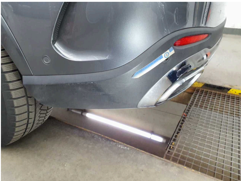
Beschädigung #1: Stossfänger hinten: Spoiler - verkratzt / verschürft - erneuern
