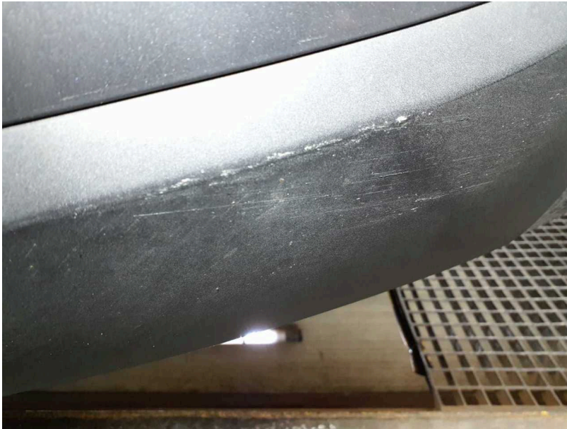
Beschädigung #1: Stossfänger hinten: Spoiler - verkratzt / verschürft - erneuern
