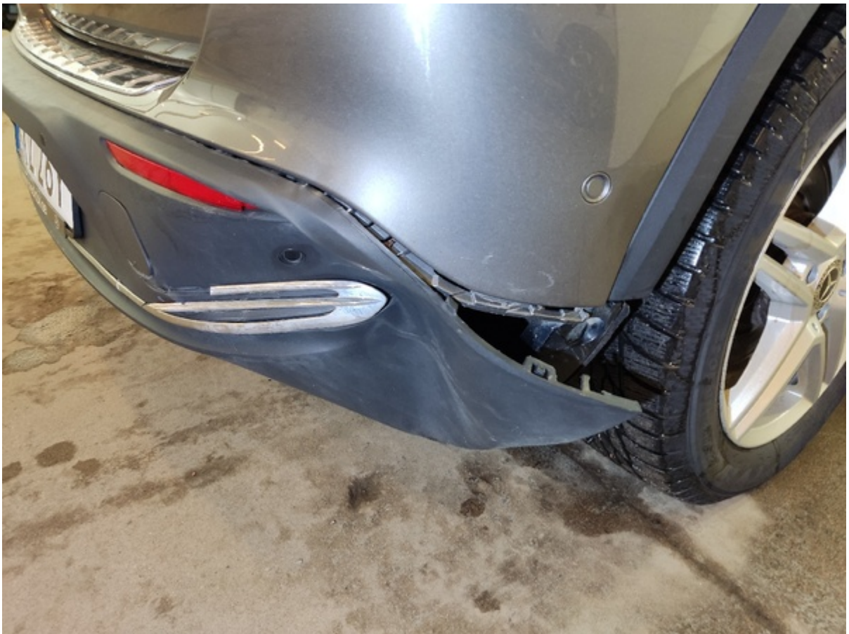
Stötfångare Bak Sprickor, stora över 10 cm 4 500 kr
