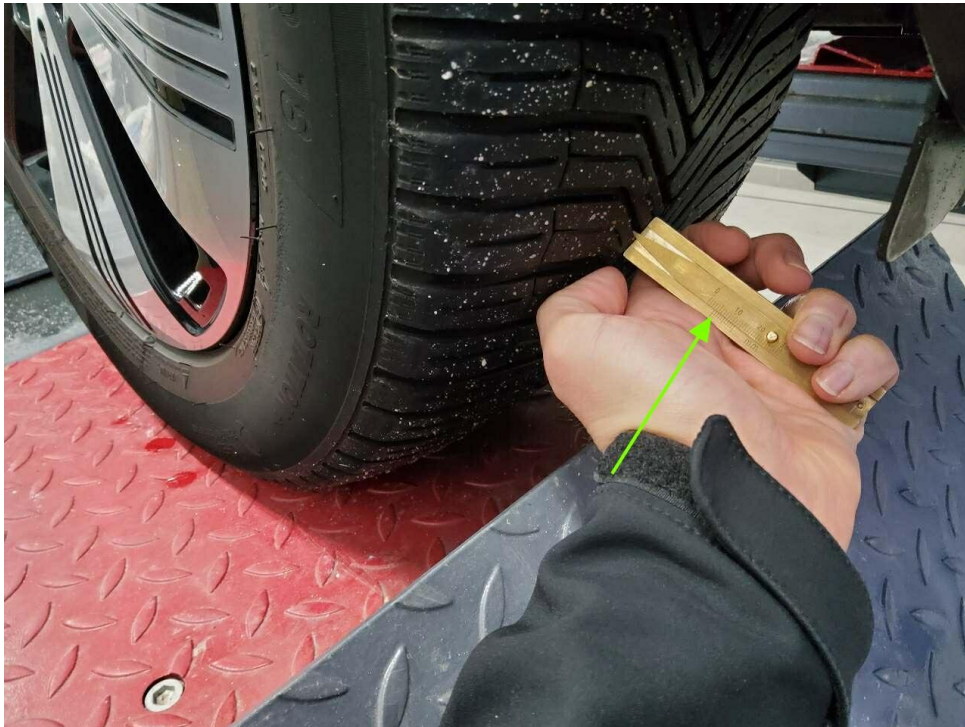
Bild 25 : Reifen vorne rechts abgefahren, laut Herstellervorgaben Reifen vorne rechts mit ersetzen wegen Profiltiefenunterschied
