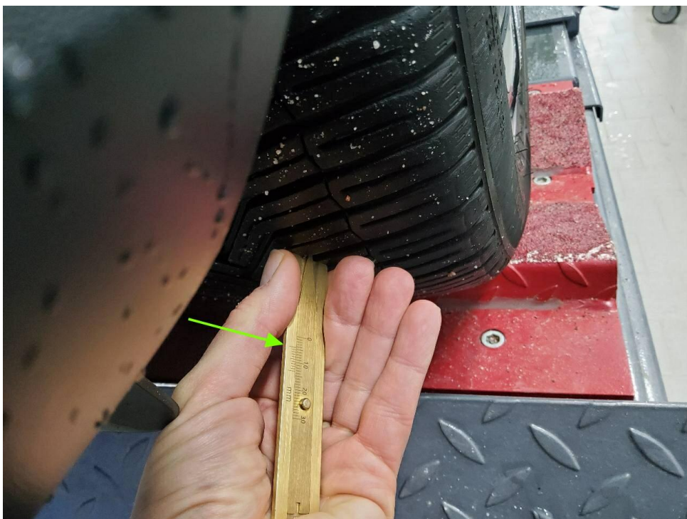
Bild 26 : Reifen vorne rechts abgefahren, laut Herstellervorgaben Reifen vorne rechts mit ersetzen wegen Profiltiefenunterschied
