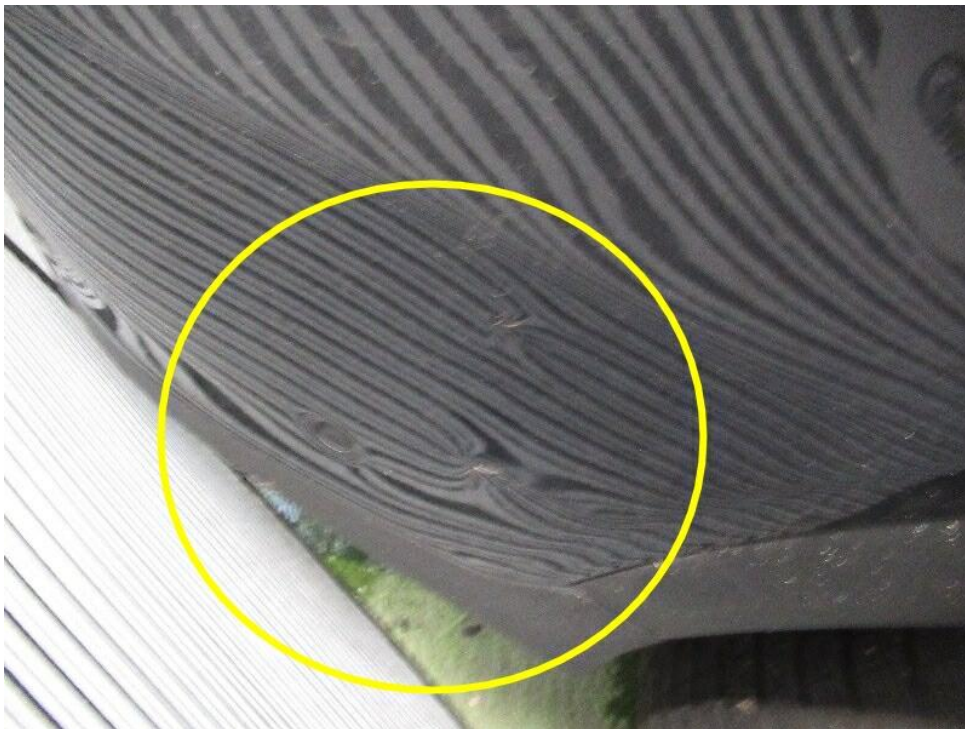
Bild 19 : Stoßfänger hinten rechts verformt / gerissen
