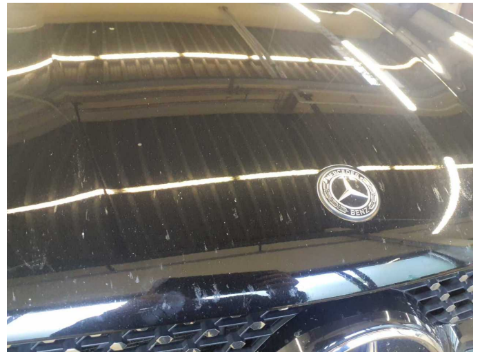
Damage 6: Bonnet: Bonnet (Sandstrahleffekt) - Stone chips - Paint
