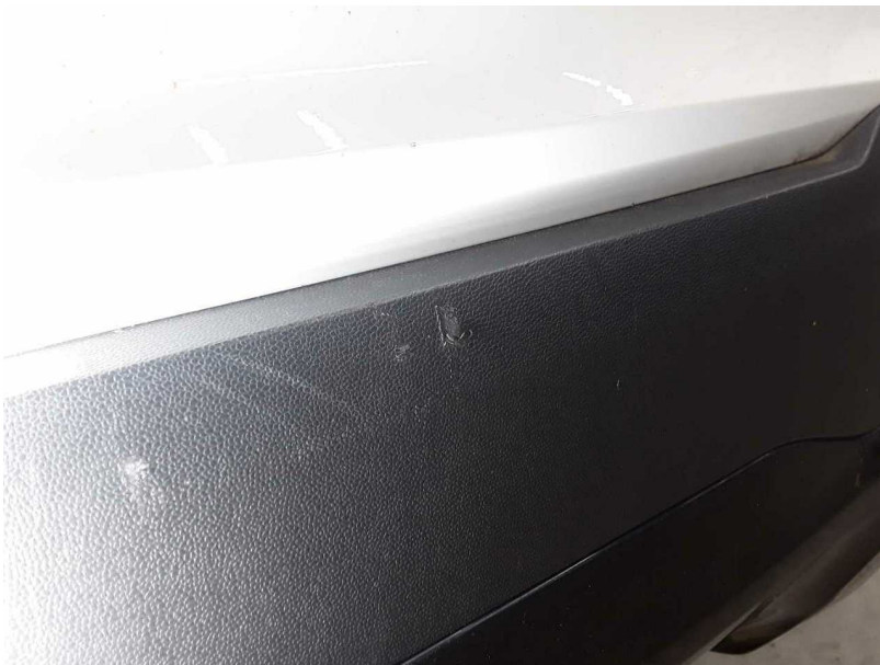
Beschädigung #13: Stossfänger hinten: Stossfänger hinten (+ Diffusor und Zierleiste ersetzen) - Kratzer - lackieren
