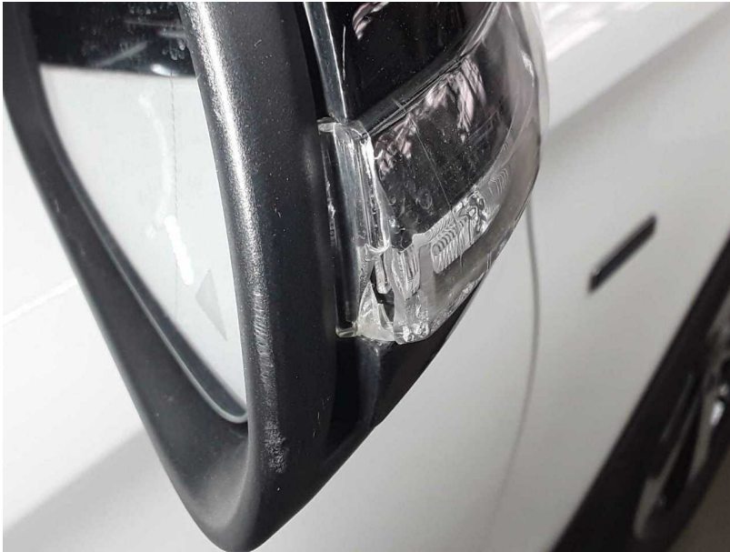
Beschädigung #3: Blinkleuchte: Spiegel rechts - gebrochen / gerissen - erneuern
