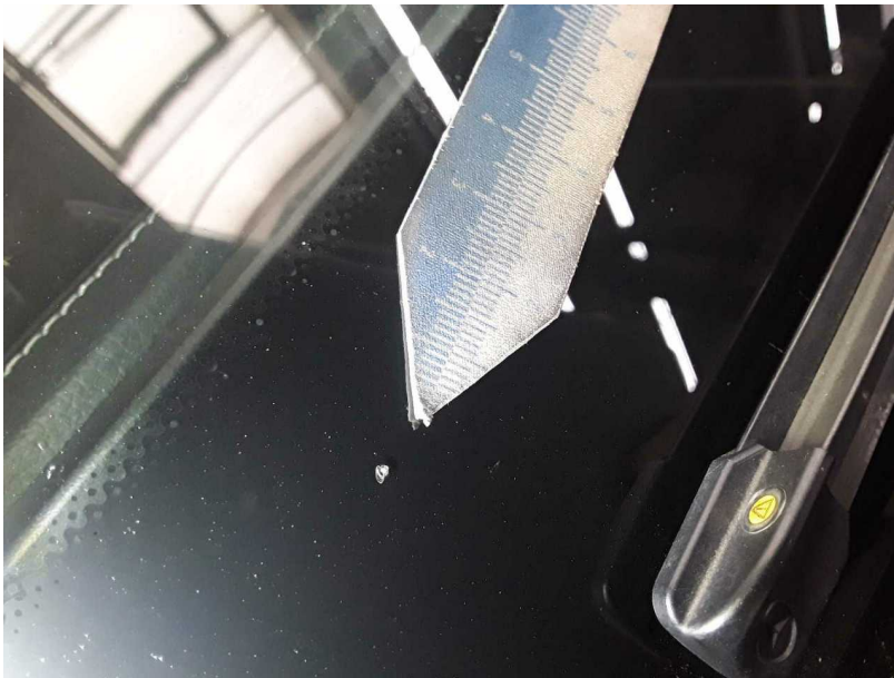
Beschädigung #15: Verglasung: Frontscheibe - Steinschlag - erneuern
