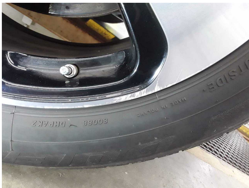
Beschädigung #9: Rad/Reifen: Felgensatz komplett (3x) - Kratzer - Wertminderung
