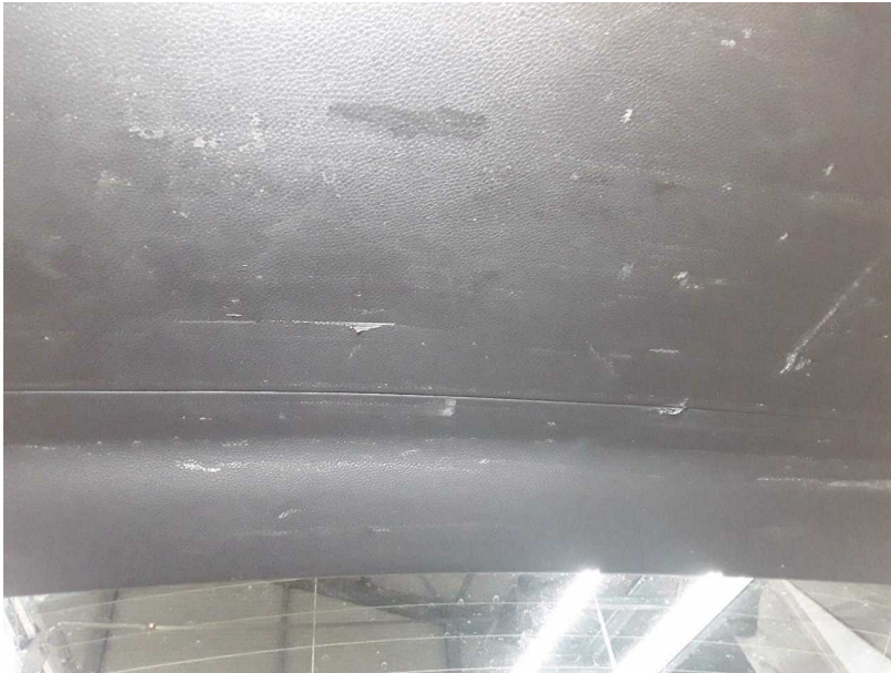
Beschädigung #7: Verkleidungen/Abdeckungen: Heckdeckel, Innenverkleidung - Kratzer - erneuern
