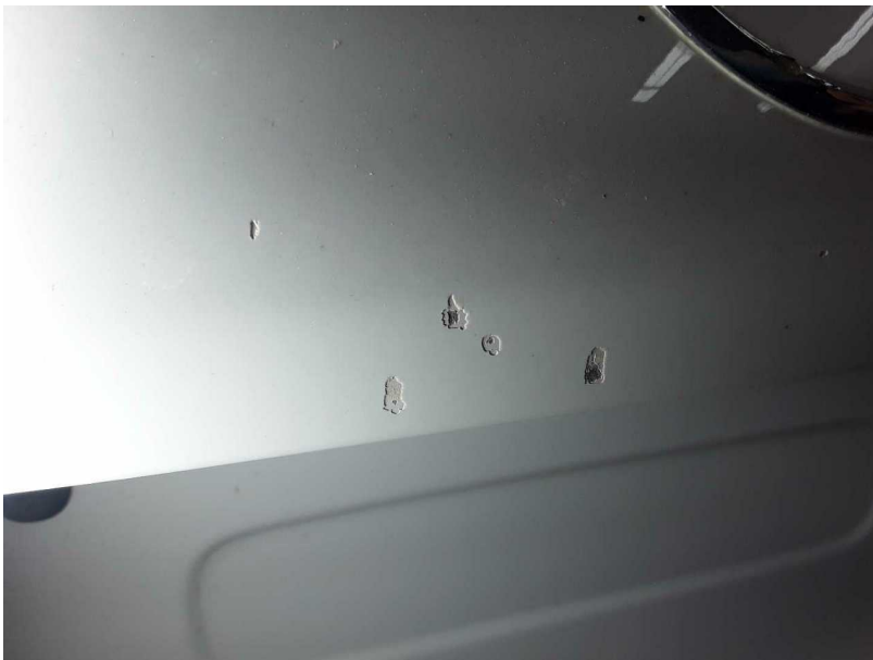
Beschädigung #11: Heckklappe/-tür: Heckklappe - Kratzer - lackieren
