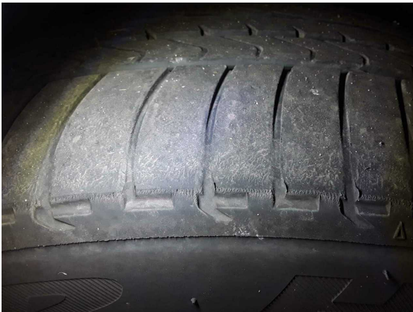
Beschädigung #4: Vermessung: Fahrwerk (Reifen einseitig abgefahren) - Fehlstellung - vermessen
