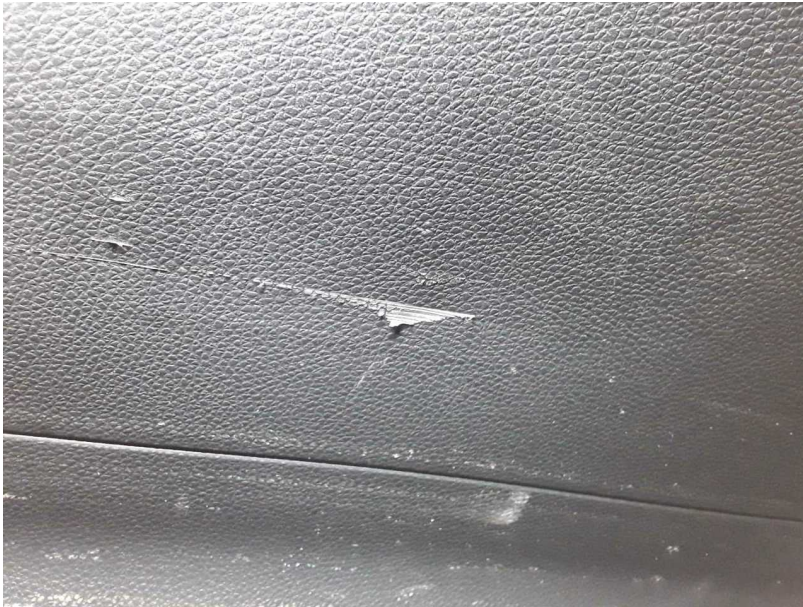
Beschädigung #7: Verkleidungen/Abdeckungen: Heckdeckel, Innenverkleidung - Kratzer - erneuern
