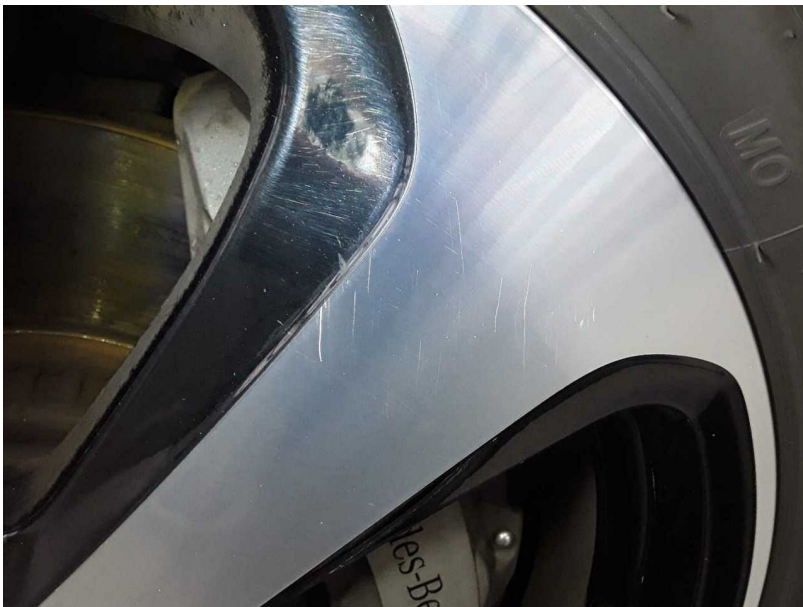
Beschädigung #9: Rad/Reifen: Felgensatz komplett (3x) - Kratzer - Wertminderung
