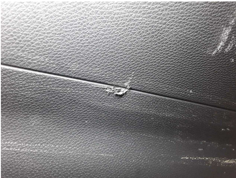
Beschädigung #7: Verkleidungen/Abdeckungen: Heckdeckel, Innenverkleidung - Kratzer - erneuern
