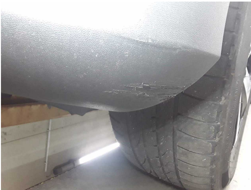
Beschädigung #14: Stossfänger vorn: Stossfänger vorn (+ Blende VLU und Blende Grill unten ersetzen) - Kratzer - lackieren
