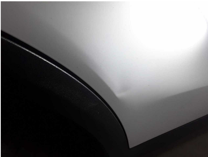
Beschädigung #12: Tür hinten rechts: Tür - Delle(n) - instandsetzen und lackieren
