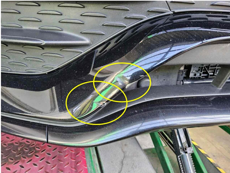
Bild 22 : Stoßfänger vorne, deformiert, erneuern
