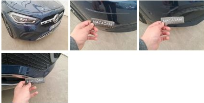
Moulure de pare-chocs AV, Déformé / Forcé, E - Remplacer
