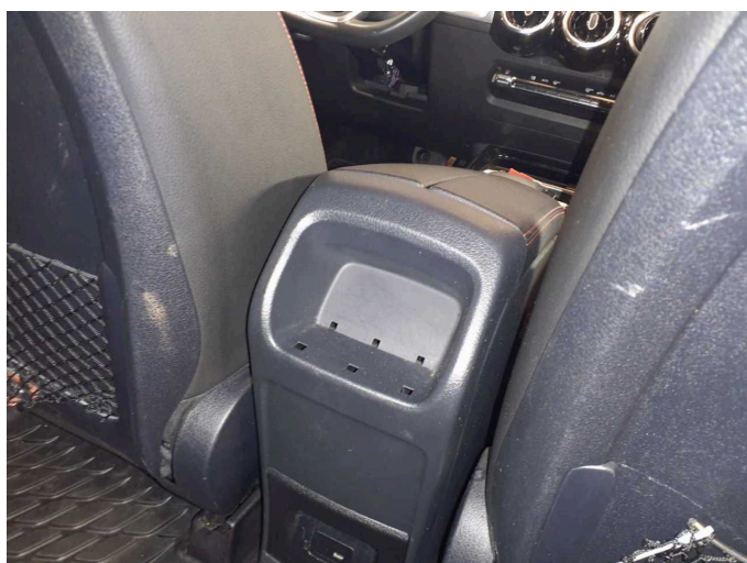
Damage 2: Seat - rear: Armrest - centre (Verkleidung/ Folgekosten möglich) - Missing - Replace
