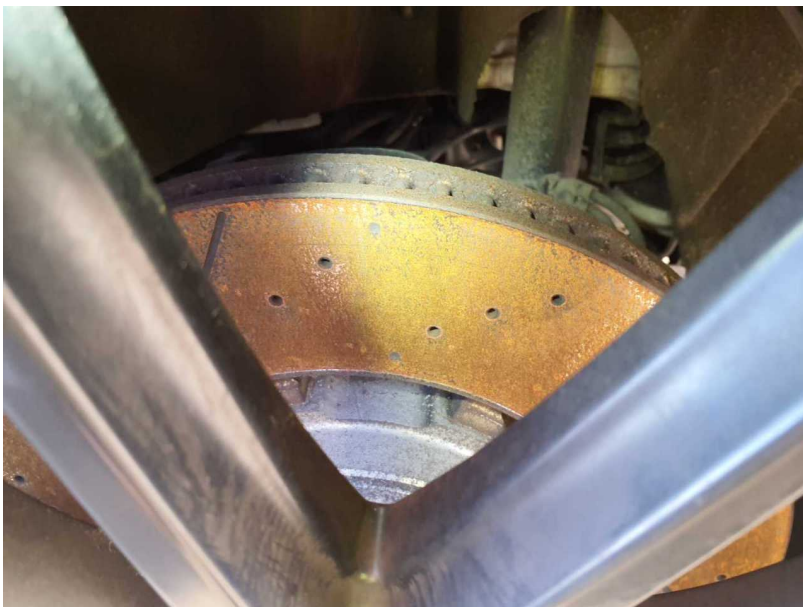
Beschädigung #5: Bremsanlage: Bremsscheiben und Beläge hinten - Korrosion - erneuern
