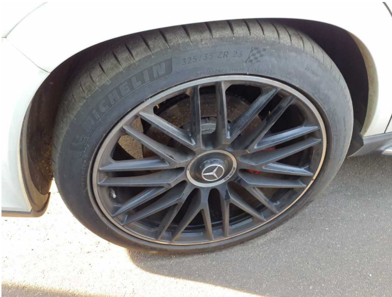
Beschädigung #8: Rad/Reifen: Leichtmetallfelge hinten rechts - verkratzt / verschürft - erneuern
