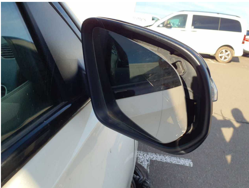
Beschädigung #3: Außenspiegel rechts: Spiegelglas - Funktion / Zulässigkeit - erneuern
