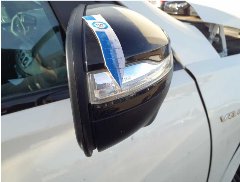
Beschädigung #2: Blinkleuchte: Spiegel rechts - verkratzt / verschürft - erneuern
